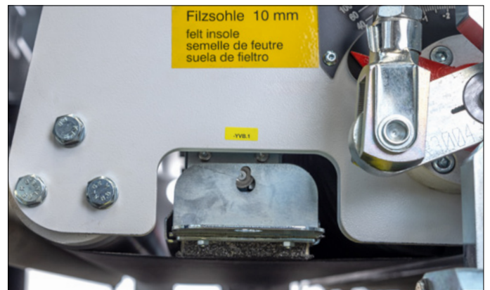
Kombiaggregat mit pneumatisch zustellbarer Schleifwalze und Segmentschleifschuh CSD
