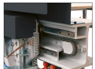
Massive Konstruktion mit H-Träger
