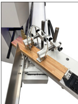
Automatisches Anschlagsystem 3.4 Meter, beidseitig 45° schrägstellbar
