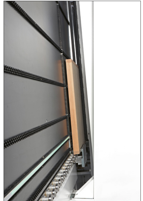
Werkstückhandling mit 5 Grad Neigung
