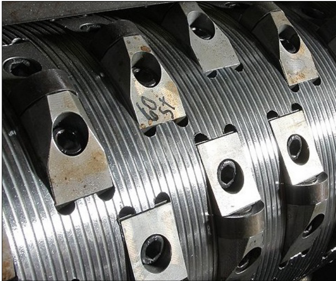
Rotor version V5 mit geschraubten Messertträgern
