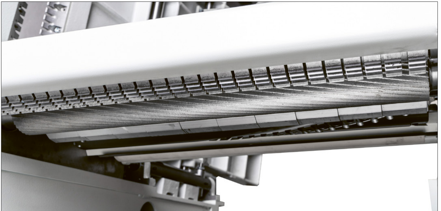
Spiraleinzugswalze mit Gliederdruckbalken
