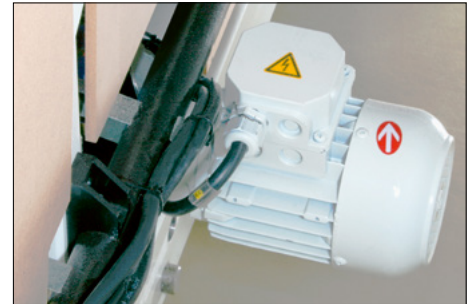
Sägerostverstellung über Elektromotor mit Überlastsicherung
