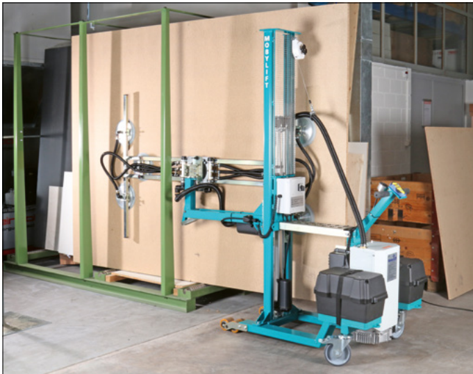
Entnahme einer Platte aus dem vertikalen Plattenlager
