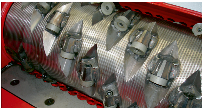
Rotor Version V7 geschweißte Messertträger
