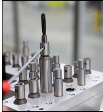
Weldon Wechselsystem für einen Bohrerwechsel mit Werkzeugen
