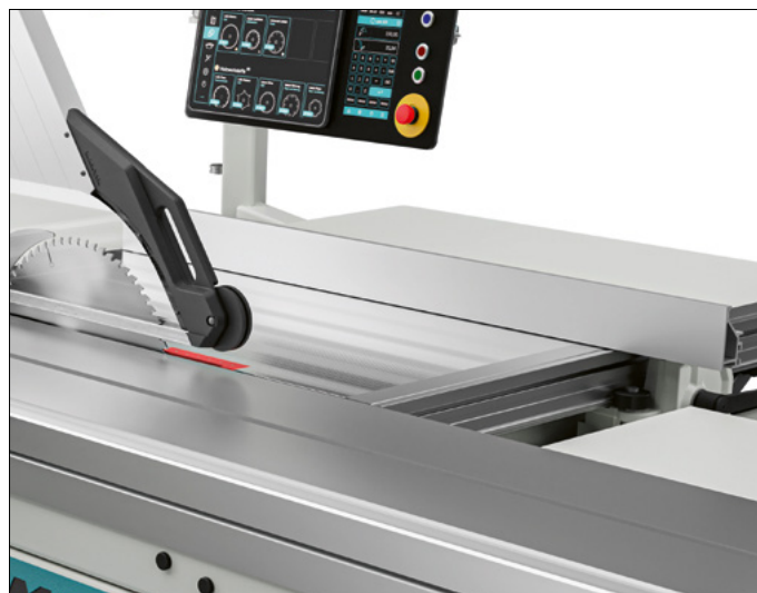
Parallelanschlag T66/T77 mit digitaler Massanzeige /T7740/1
