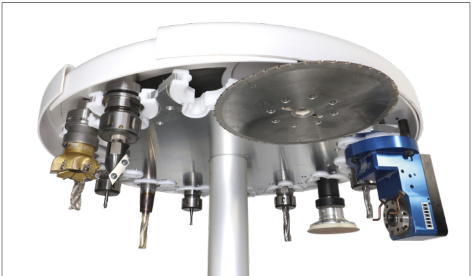
14-fach-Tellerwechsler In X-Richtung, mitfahrend
