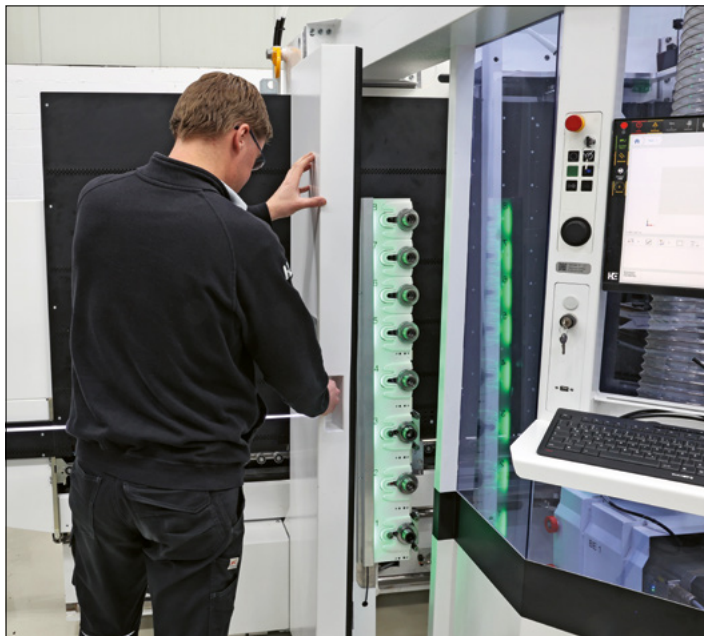
Bequemer Werkzeugwechsel mit Hilfe von Assistenzsystem-IntelliGuide
