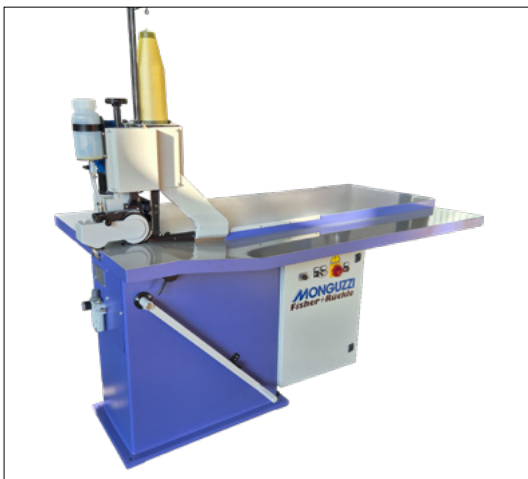
Furnierzusammensetzmaschine MONGUZZI Fisher + Rückle Stitchmaster
