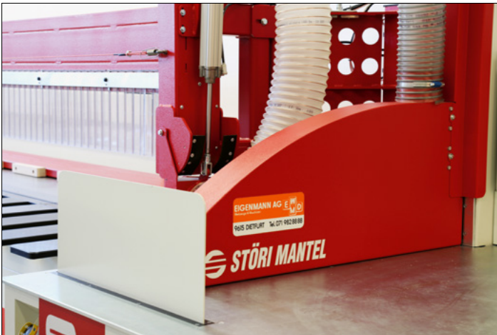
Schutzschild, pneumatisch ausgefahren
