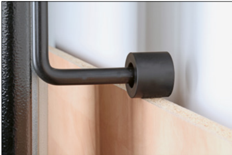
Streifenanschlag bis 580 mm für horizontale Schnitte
