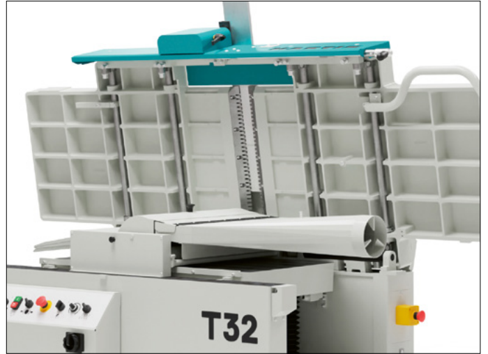
Abricht-Dickenhobelmaschine MARTIN T32, gerüstet für den Dickenbetrieb
