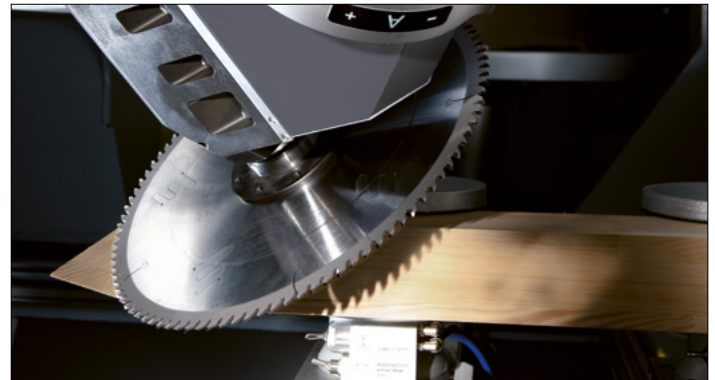
Schifterschnitt mit grosser Schnitttiefe für Rahmenteile
