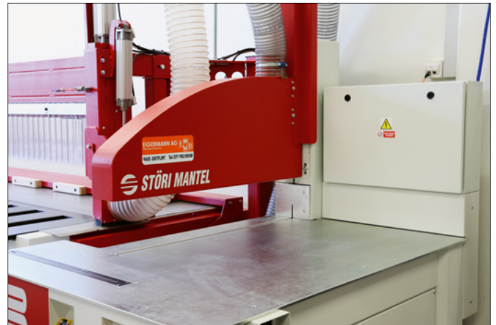
Schaltschrank, nach vorne zu öffnen
