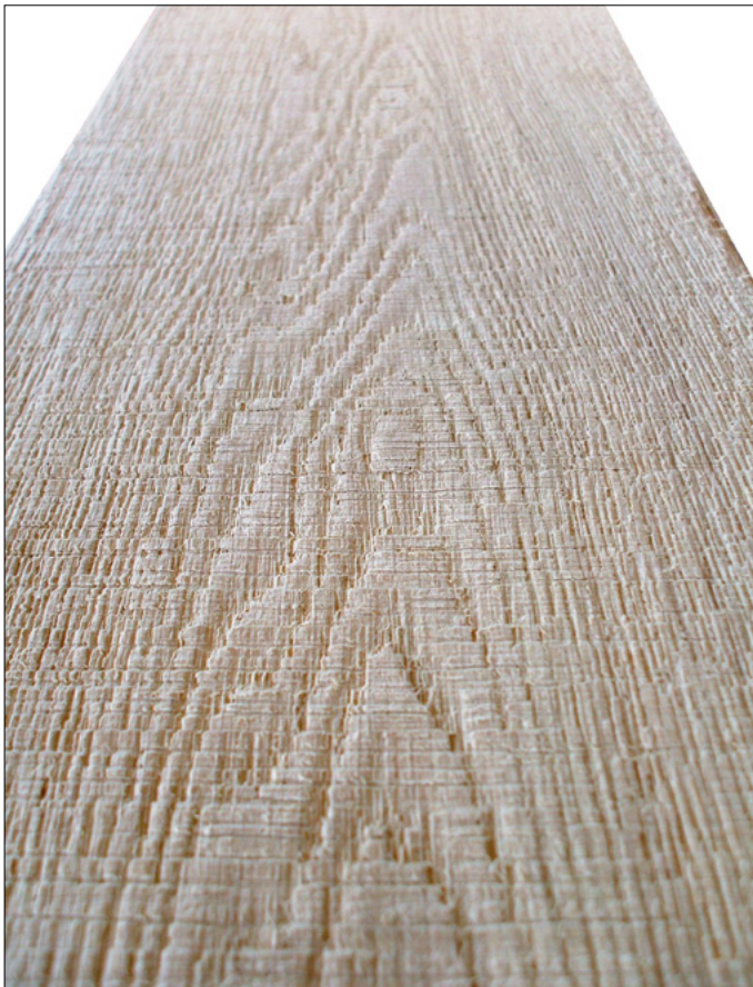
Mit dem zusätzlichen Queraggregat lässt sich eine sägeraue Optik perfekt herstellen
