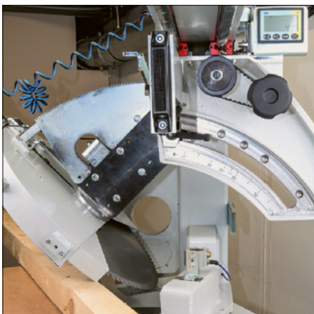
Neigung bis 45° stufenlos mit Fixraster
