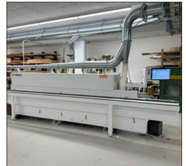
Kantenanleimmaschine HOMAG KDF 440 EDITION
