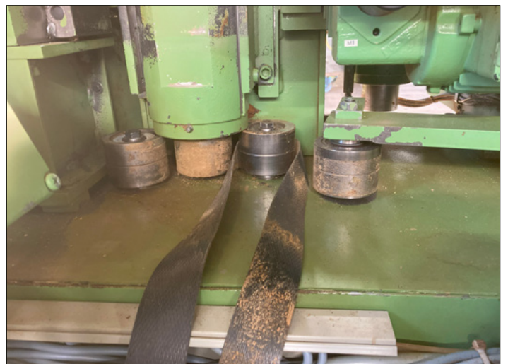
Umlenkrollen werden neu gelagert
