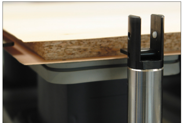
Anschläge bei Deckschichtüberstand
