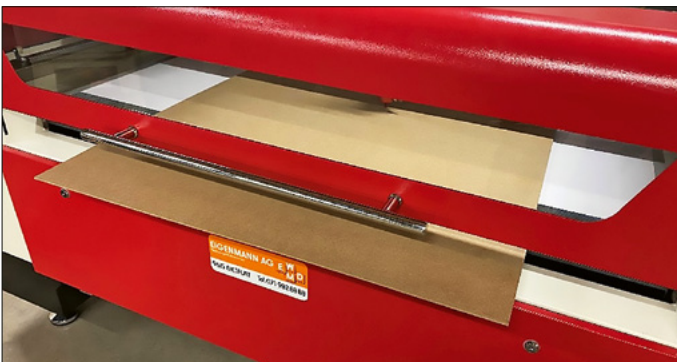
Unbeschränkte Werkstückgröße in Y-Richtung bis zu einer Werkstückdicke von 70 mm
