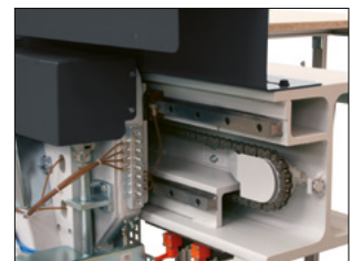
Massive Konstruktion mit H-Träger
