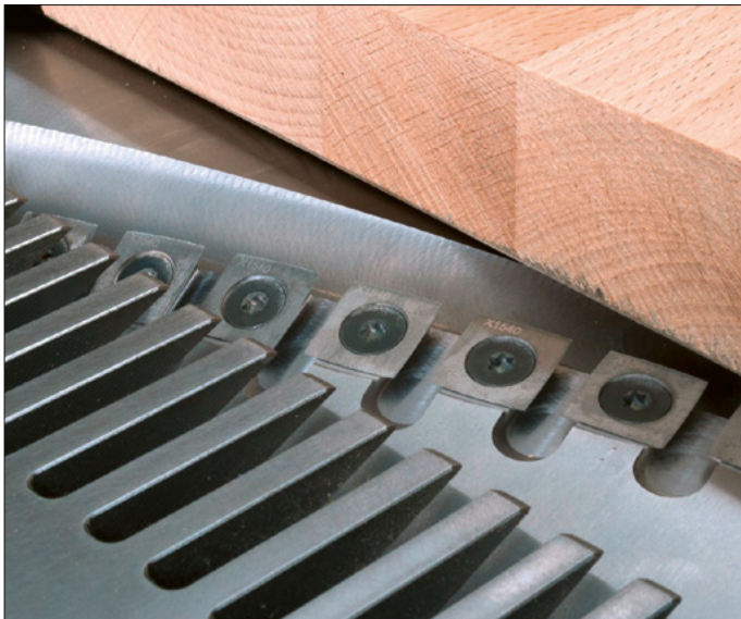
Vollstahl-Messerwelle Xplane mit 3 spiralförmigen Messerreihen
