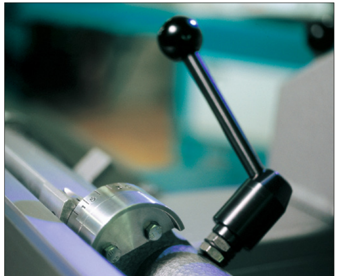
Einhandverstellung für die Anschlagneigung
