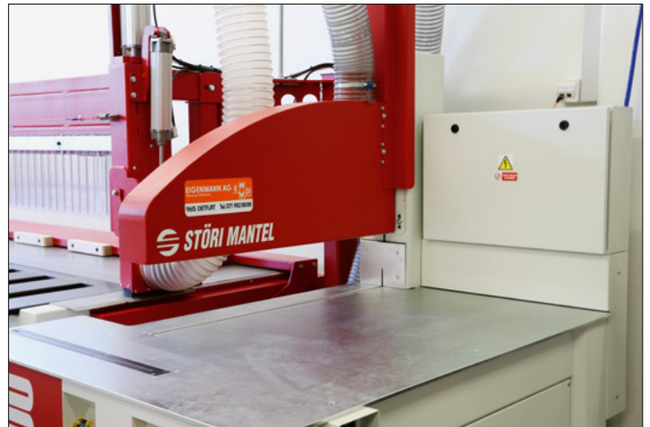
Schaltschrank, nach vorne zu öffnen
