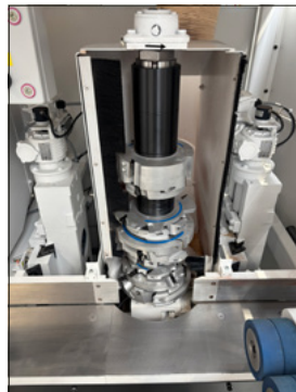
Lange Frässpindeln mit Oberlagerung für Zapfen und Profilierungen
