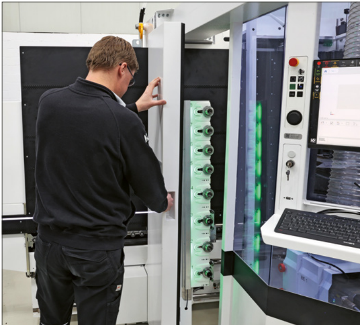
Bequemer Werkzeugwechsel mit Hilfe von Assistenzsystem-IntelliGuide
