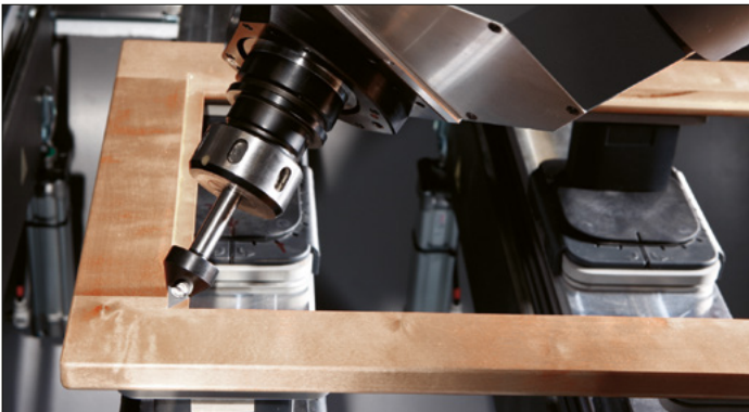
Eckiges Ausspitzen einer Glasfalz-Ecke
