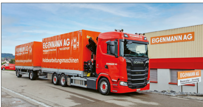
Der firmeneigene Anhängerzug mit einem 5-Tonnen-Kran für fachgerechte Auslieferungen
