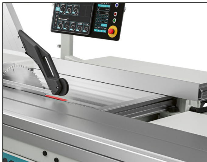
Parallelanschlag T66/T77 mit digitaler Massanzeige /T7740/1
