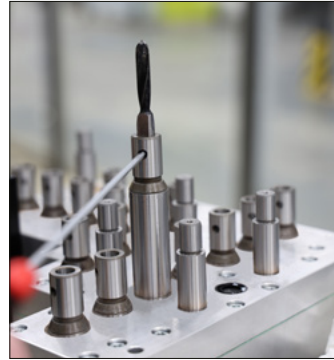
Weldon Wechselsystem für einen Bohrerwechsel mit Werkzeugen
