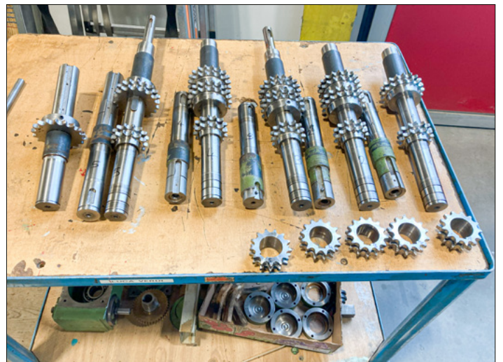
Alle Vorschubwellen werden überarbeitet und neu gelagert
