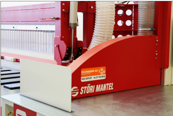
Schutzschild, pneumatisch ausgefahren
