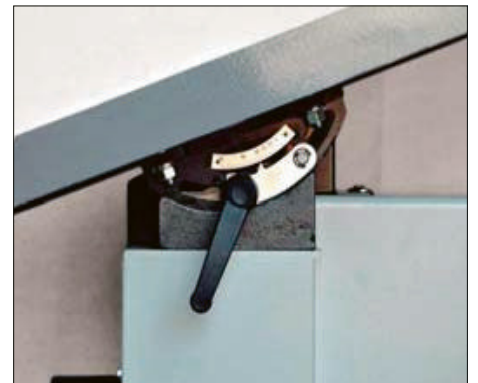
Tischschwenkeinrichtung stufenlos bis 45°
