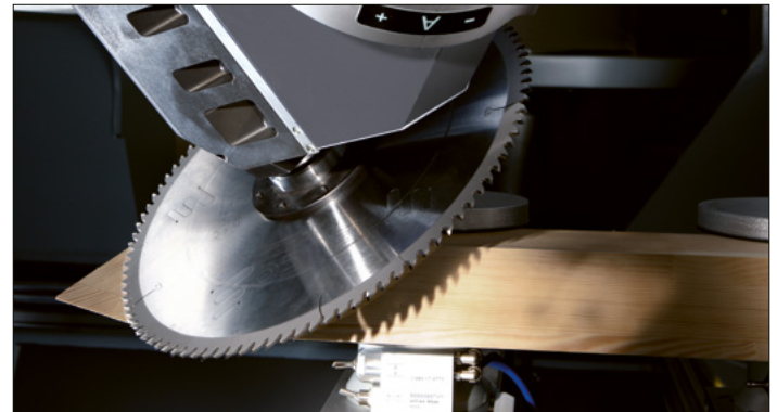
Schifterschnitt mit grosser Schnitttiefe für Rahmenteile
