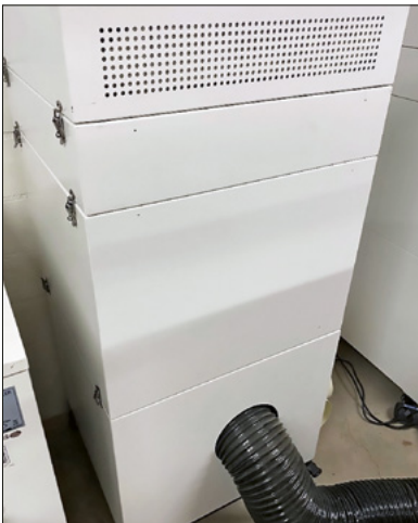
Absaugturm mit 3-fach-Filterung
