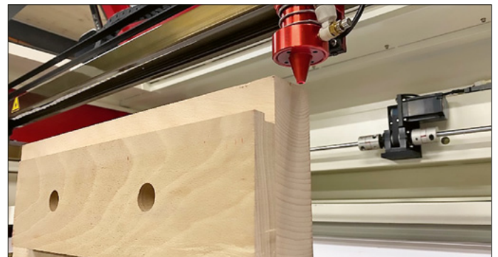
Maximale Werkstückdicke von 150 mm
