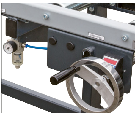
Handradverstellung mit LED-Anzeige in mm, an zentraler Bedienkonsole
