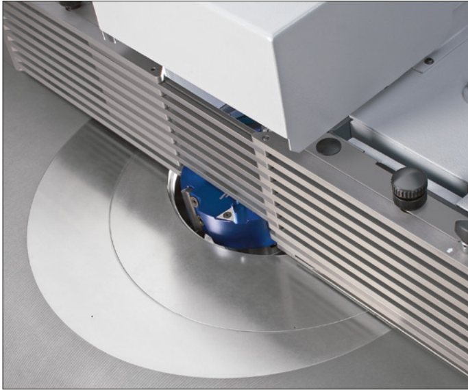
Elektromotorisch positionierbare Tischöffnung
