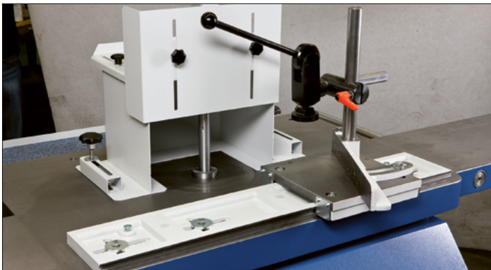
Zapfenschneid- und Schlitzapparat mit Schutzhaube
