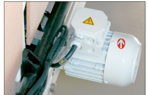
Sägerostverstellung über Elektromotor mit Überlastsicherung
