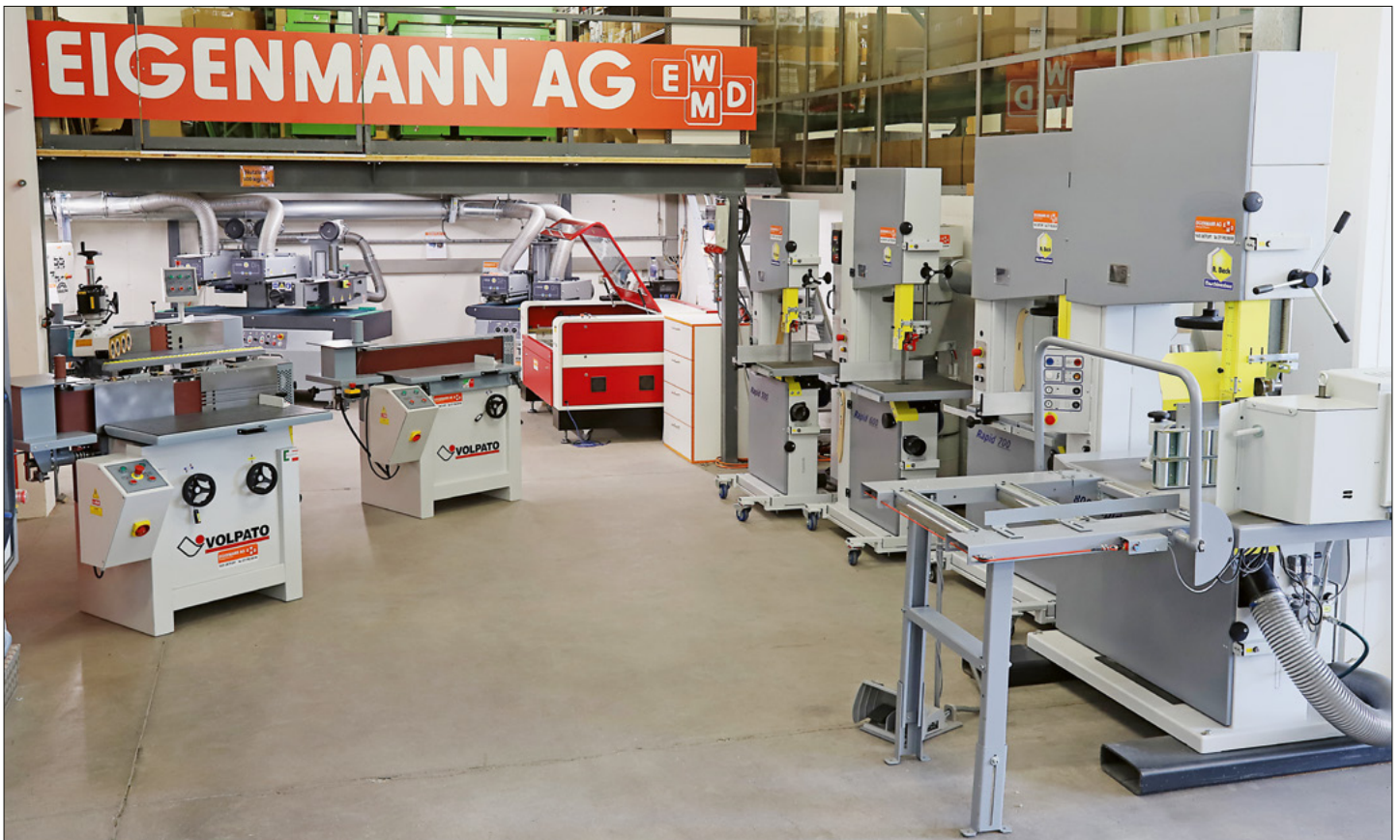
Bandsägen von Beck und Kantenschleifmaschinen von Volpato Im Hintergrund Bürstmaschinen von Sarmax und Flachbett Laser von Time Technology
