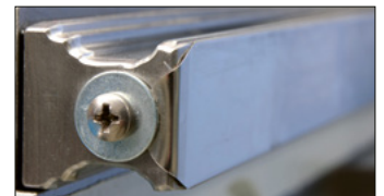
Schifterschnitt mit grosser Schnitttiefe für Rahmenteile
