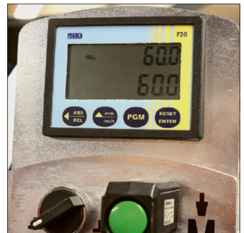
Digitalanzeigen für Neigung und Schwenkung
