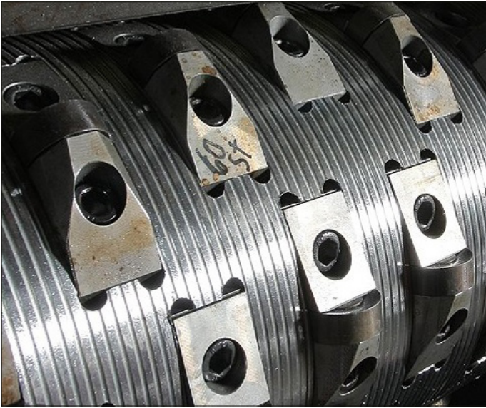
Rotor version V5 mit geschraubten Messerträgern
