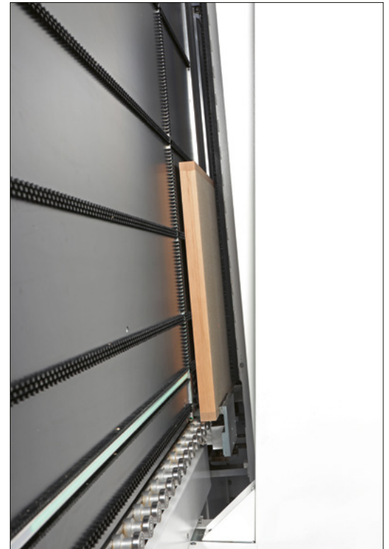
Werkstückhandling mit 5 Grad Neigung
