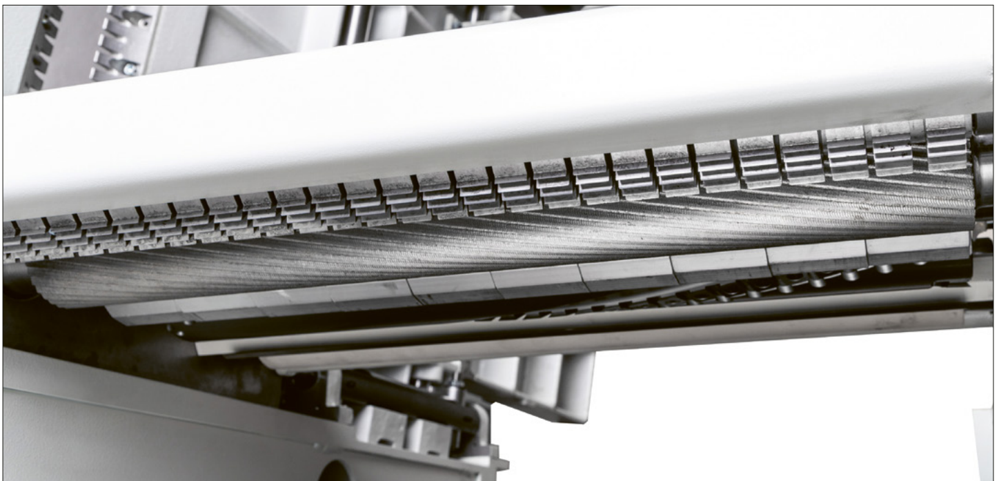
Spiraleinzugswalze mit Gliederdruckbalken
