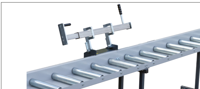
Manuell wegschwenkbarer Materialanschlag
