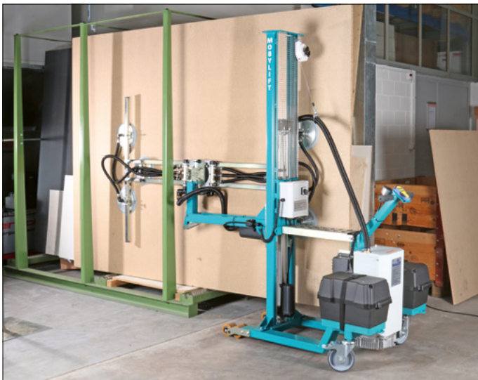
Entnahme einer Platte aus dem vertikalen Plattenlager
