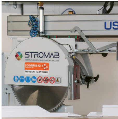
Schutzhaube pneumatisch geöffnet
