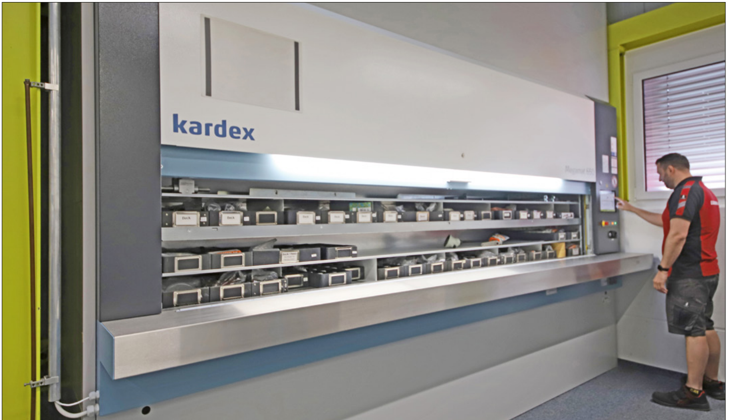
Werkstattbüro mit Umlauflager für Ersatzteile zu Stationärmaschinen
