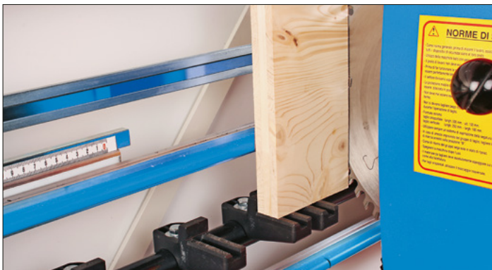
Doppelte Werkstückauflage links von der Schnittfuge für kurze Werkstücke
