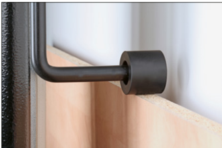
Streifenanschlag bis 580 mm für horizontale Schnitte
