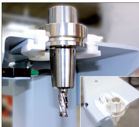
Werkzeugübergabepplatz – Sicheres und schnelles Beschicken des Werkzeugwechsellmagazins – Hohe Sicherheit durch Sensorabfrage, ob der Werkzeugübergabepplatz frei oder belegt ist
