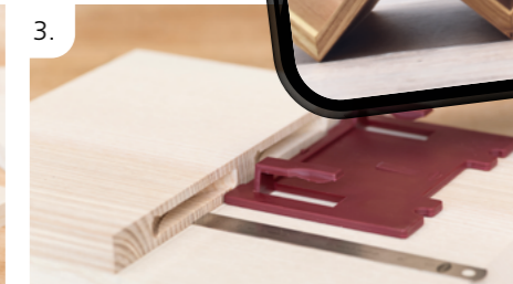
Fachboden als Anschlag mithilfe der Aufsteckplatte 2 mm versetzt ausrichten
