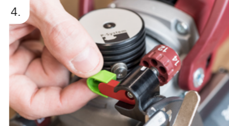
P-System Tiefenstelleraufsatz 4 mm aufstecken (effektive Frästiefe 8 mm)
