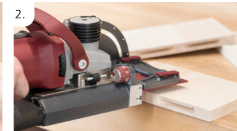
Fräsung in die Kante mit der 2 mm Aufsteckplatte (Frästiefe 12 mm)
