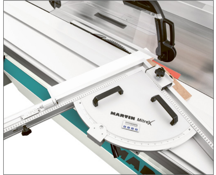
MitreX mit digitaler Winkelanzeige
