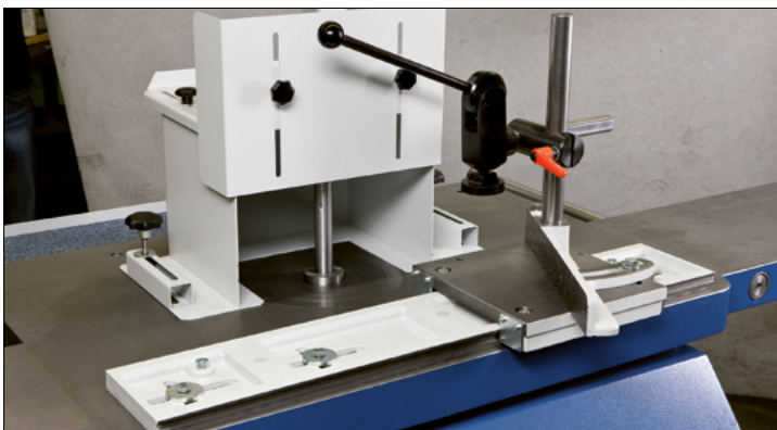
Zapfenschneid- und Schlitzapparat mit Schutzhaube
