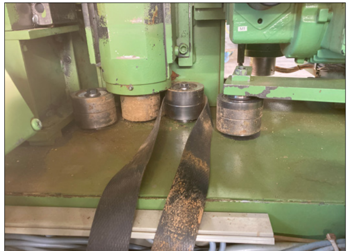
Umlenkrollen werden neu gelagert
