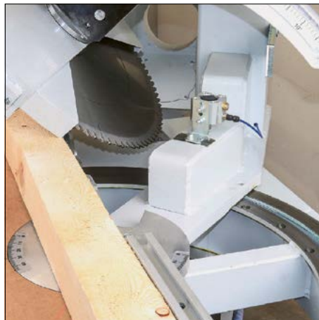
Schwenkung +60° bis -45° stufenlos mit Fixraster
