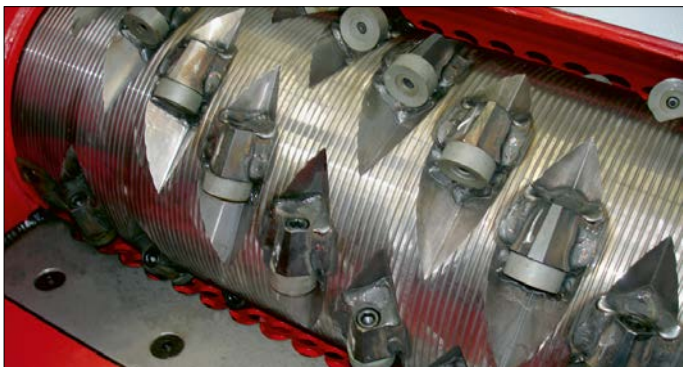
Rotor Version V7 geschweißte Messerträger
