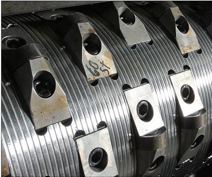
Rotor version V5 mit geschraubten Messerträgern
