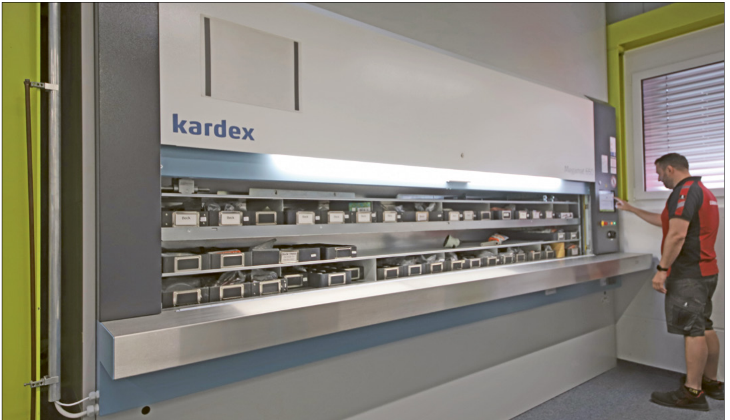
Werkstattbüro mit Umlauflager für Ersatzteile zu Stationärmaschinen
