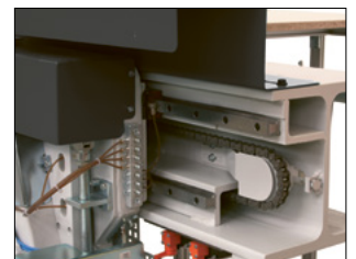
Massive Konstruktion mit H-Träger
