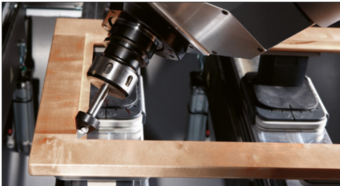
Eckiges Ausspitzen einer Glasfalz-Ecke
