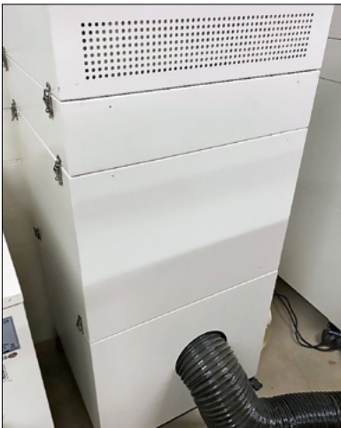
Absaugturm mit 3-fach-Filterung
