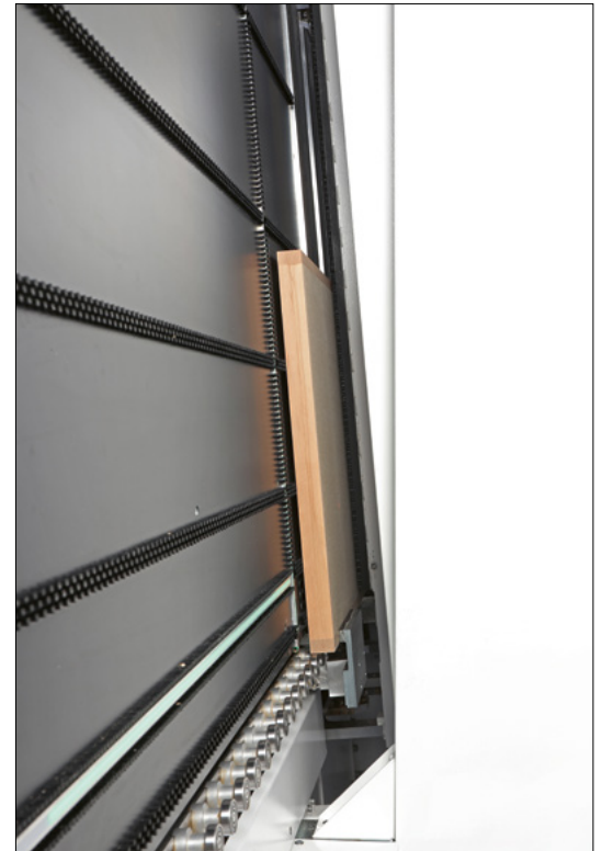
Werkstückhandling mit 5 Grad Neigung
