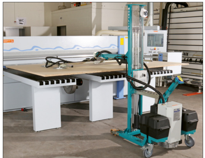
Die Platte lässt sich elektrisch abschwenken
