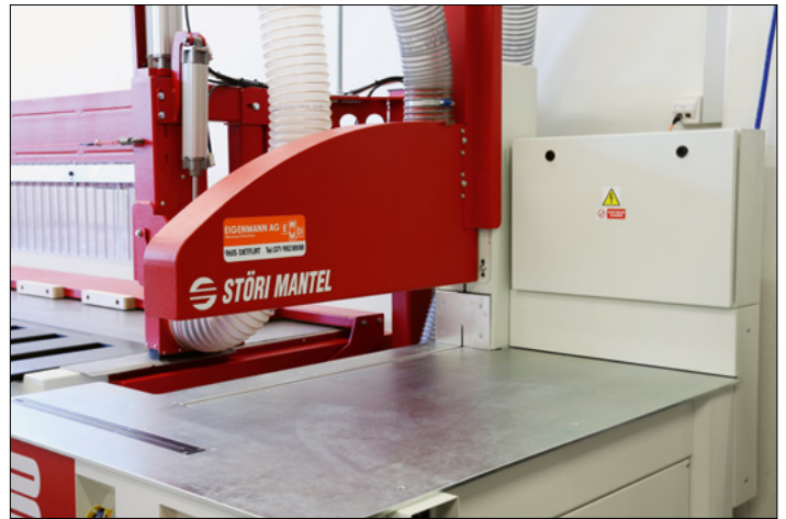
Schaltschrank, nach vorne zu öffnen
