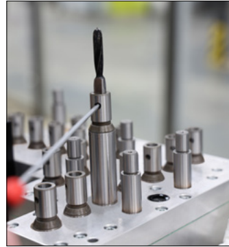
Weldon Wechselsystem für einen Bohrerwechsel mit Werkzeugen
