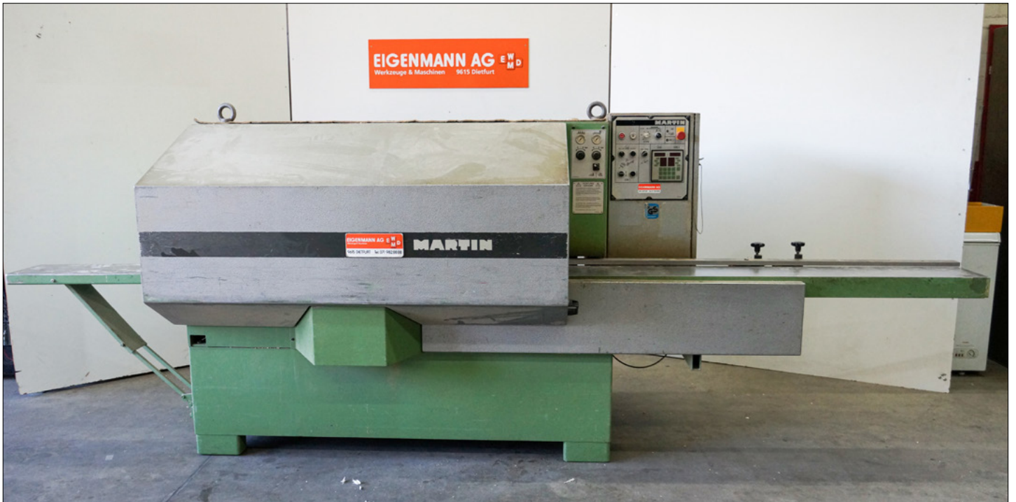
Vierseitenhobelmaschine Martin T90 vor der Revision
