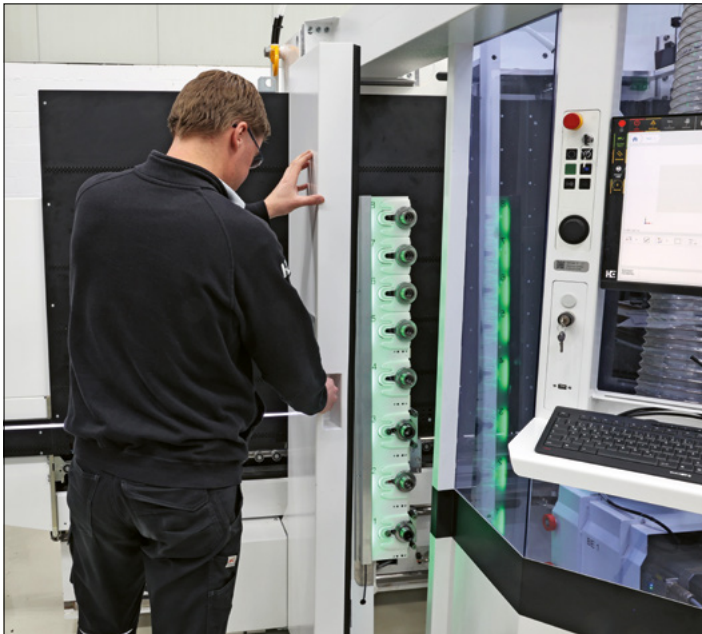
Bequemer Werkzeugwechsel mit Hilfe von Assistenzsystem-IntelliGuide
