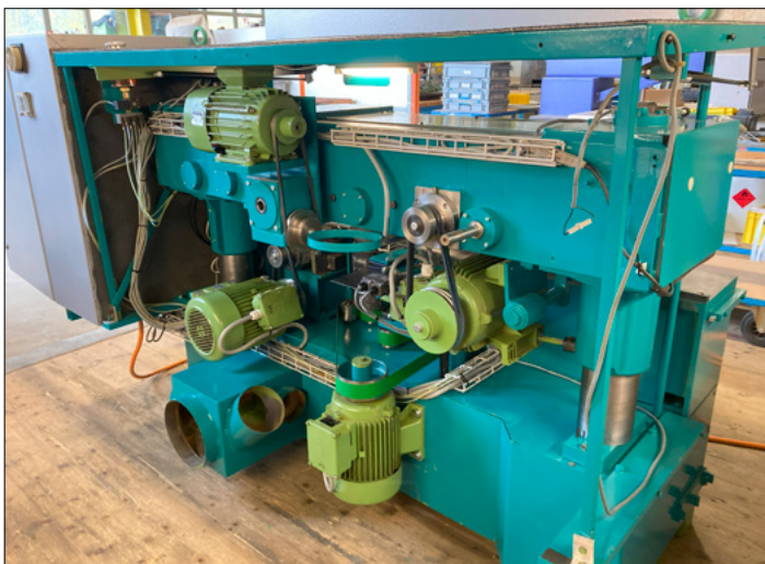
Antriebe nach der Revision fertig montiert
