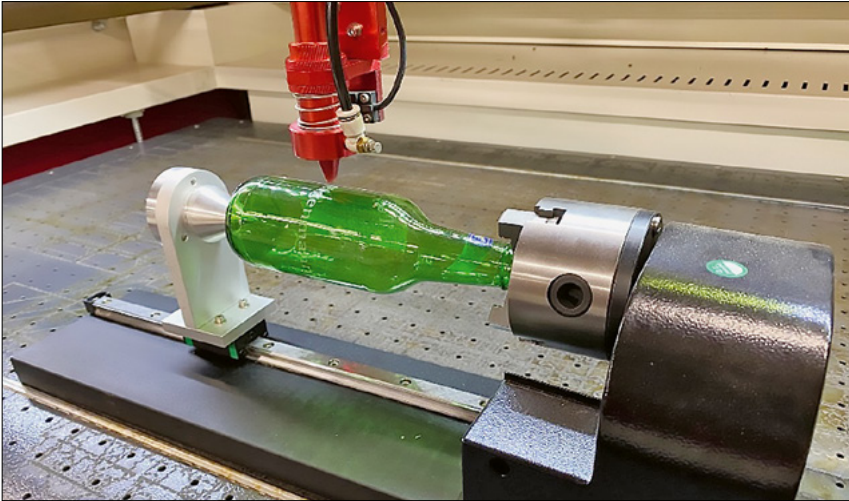
Rundgravurvorrichtung für runde Werkstücke
