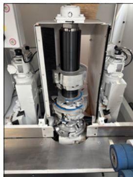
Lange Frässpindeln mit Obenlagerung für Zapfen und Profilierungen
