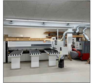
Horizontale Plattenaufteilsäge HOMAG B-130
