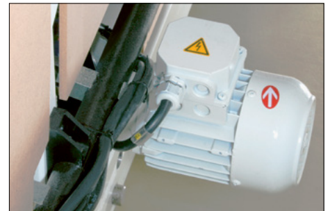
Sägerostverstellung über Elektromotor mit Überlastsicherung
