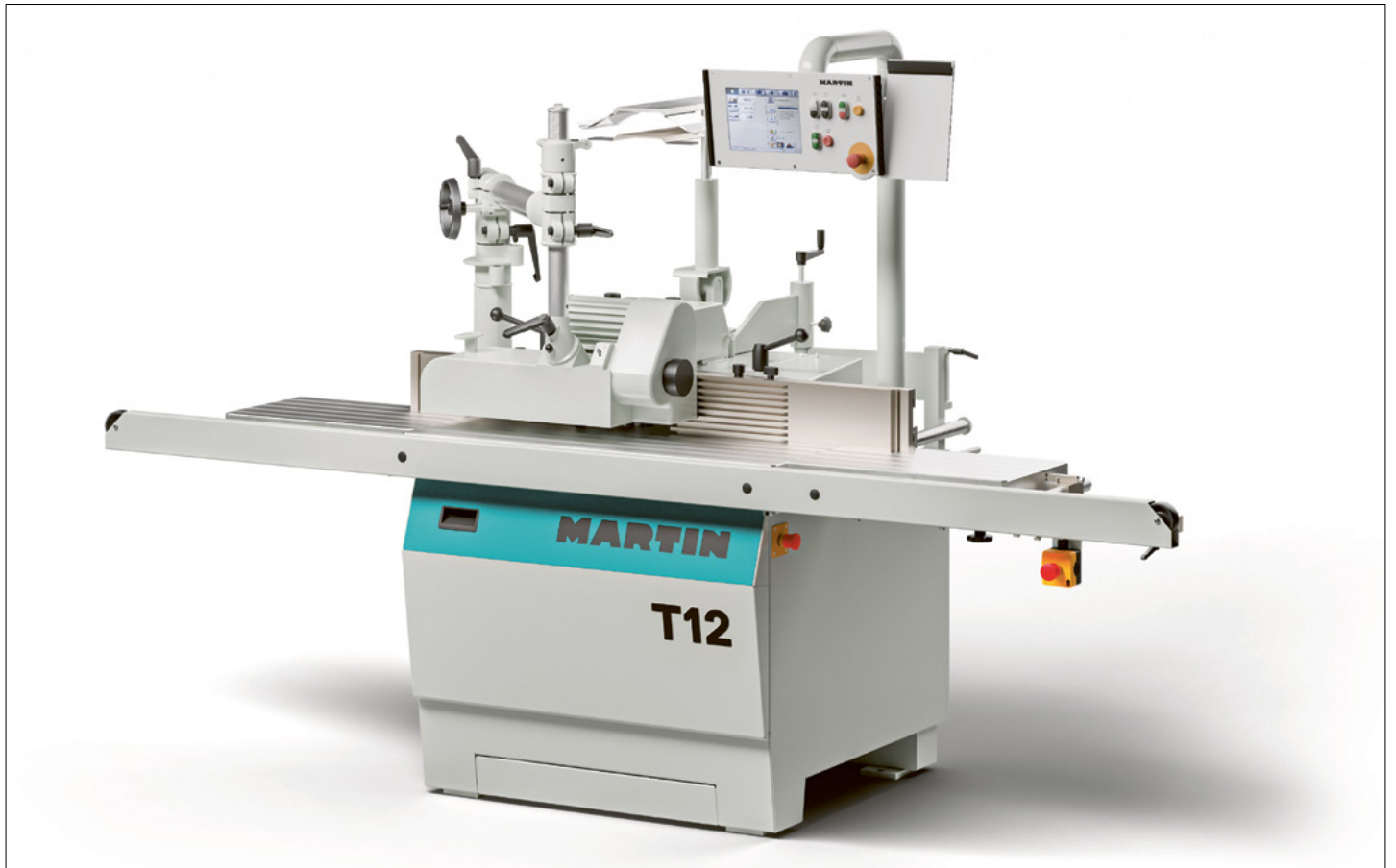
Kehlmaschine MARTIN T12, starr, mit Tischverbreiterung und Rahmenauszug
