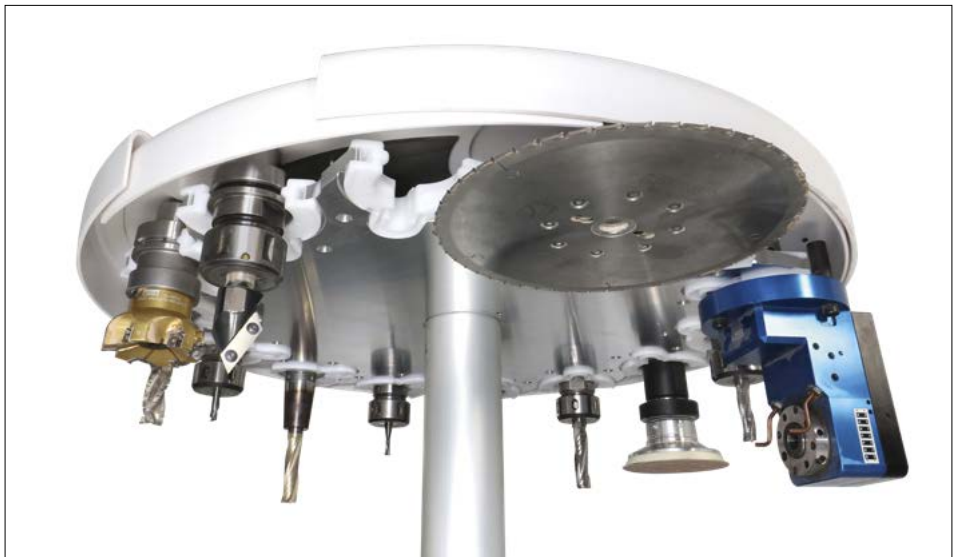
14-fach-Tellerwechsler In X-Richtung, mitfahrend
