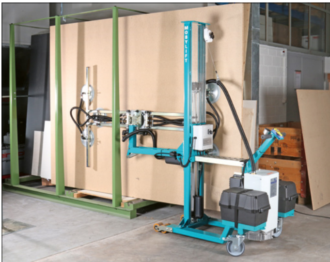
Entnahme einer Platte aus dem vertikalen Plattenlager
