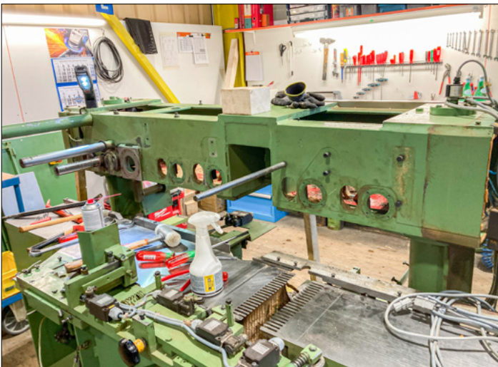
Maschine komplett zerlegt
