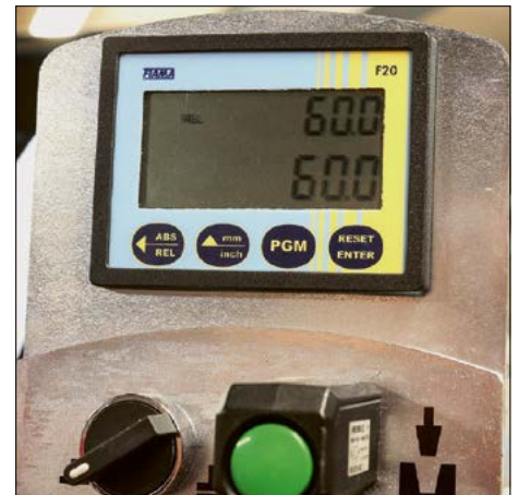
Digitalanzeigen für Neigung und Schwenkung
