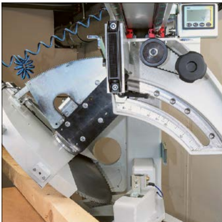
Neigung bis 45° stufenlos mit Fixraster
