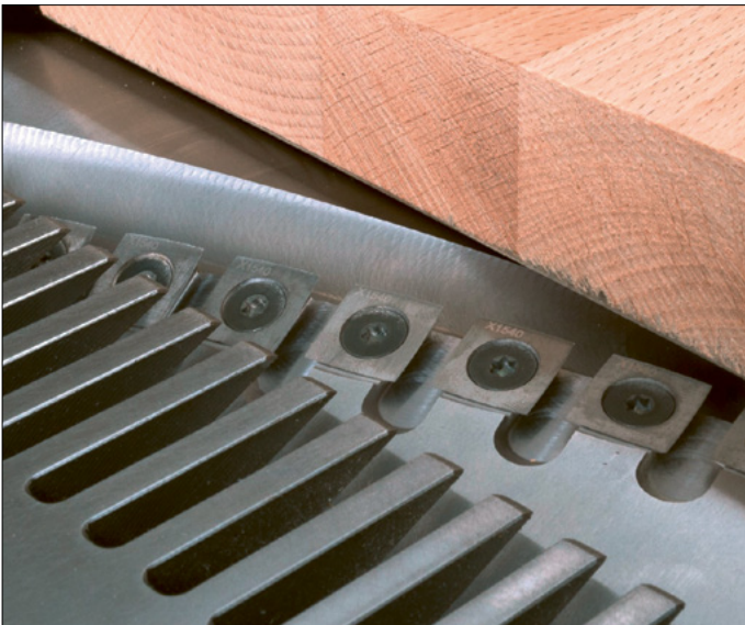
Vollstahl-Messerwelle Xplane mit 3 spiralförmigen Messerreihen
