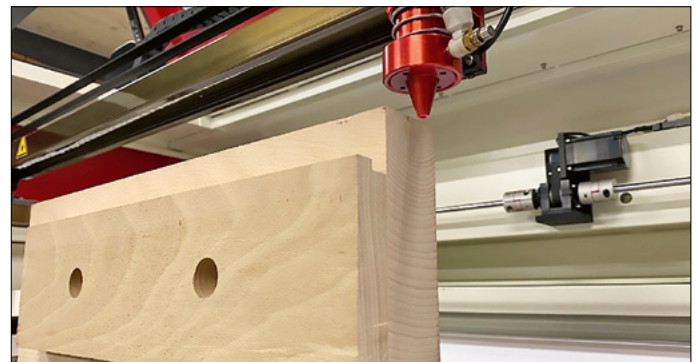
Maximale Werkstückdicke von 150 mm
