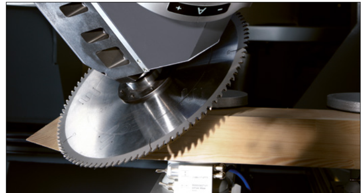
Schifterschnitt mit grosser Schnitttiefe für Rahmenteile
