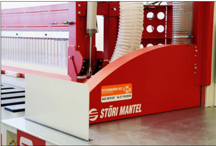
Schutzschild, pneumatisch ausgefahren
