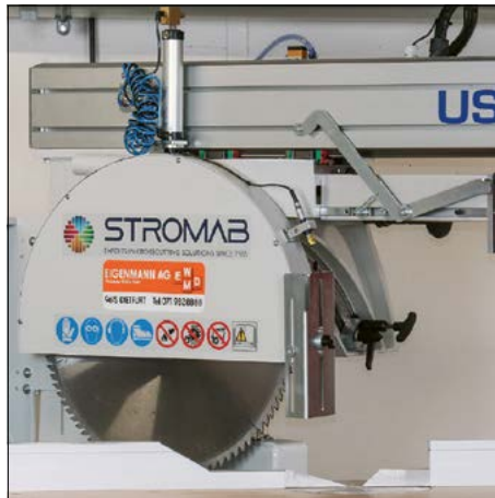
Schutzhaube pneumatisch geöffnet
