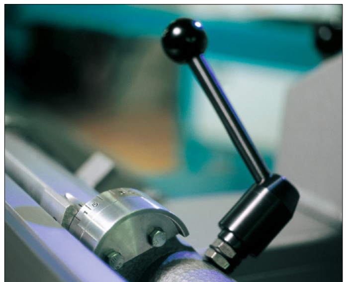
Einhandverstellung für die Anschlagneigung
