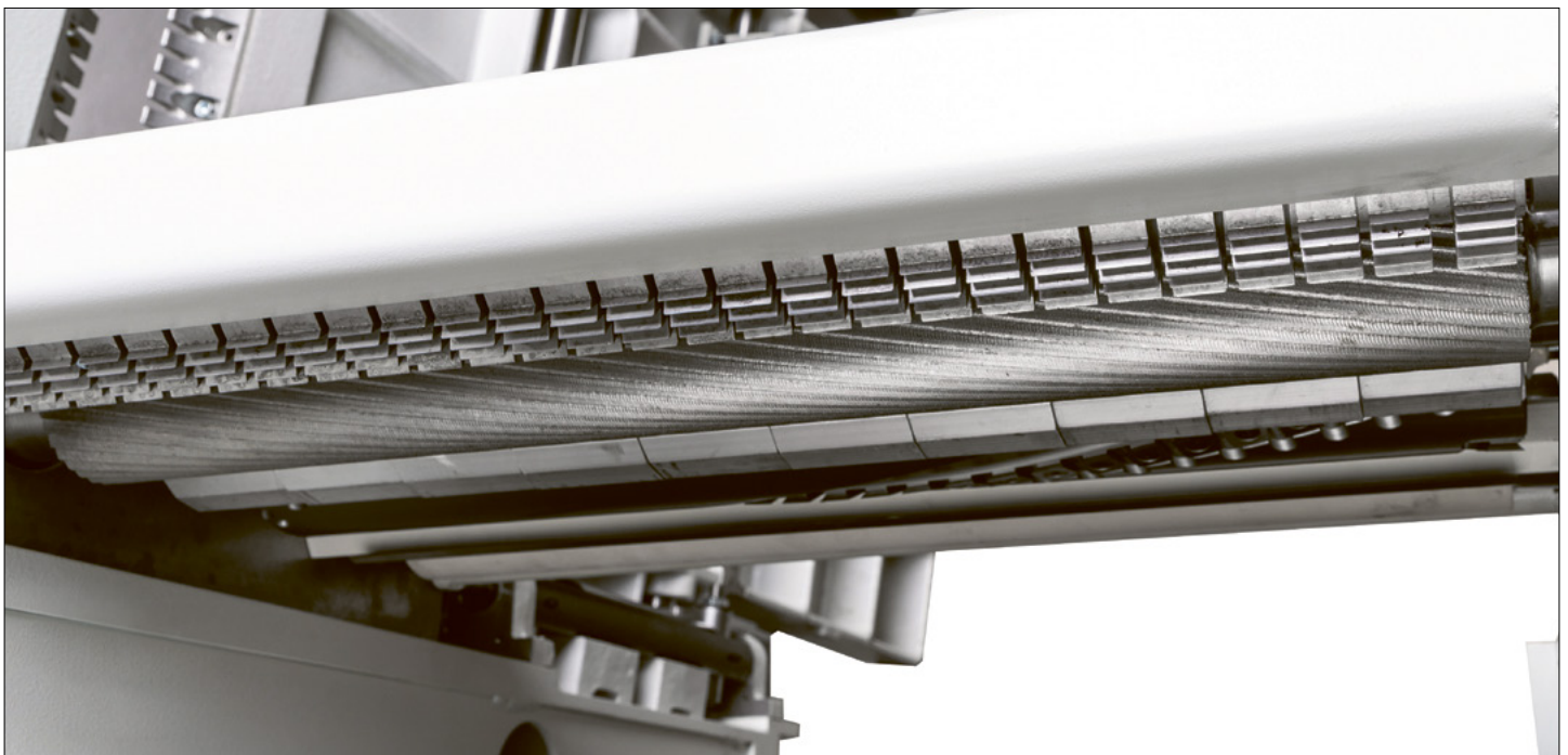
Spiraleinzugswalze mit Gliederdruckbalken
