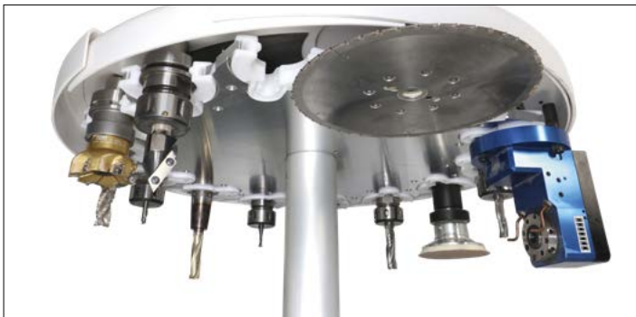
14-fach-Tellerwechsler in X-Richtung, mitfahrend
