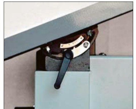
Tischschwenkeinrichtung stufenlos bis 45°
