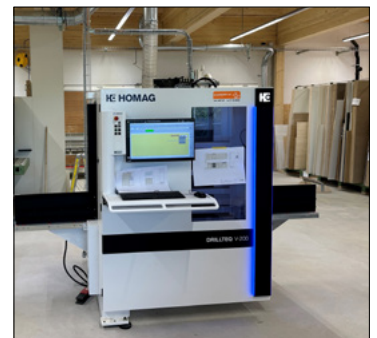
Vertikales CNC-Bearbeitungs- zentrum HOMAG V-200
