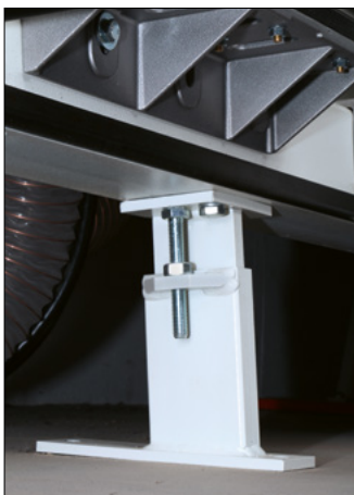
Fünf einzeln nivellierbare Standfüsse
