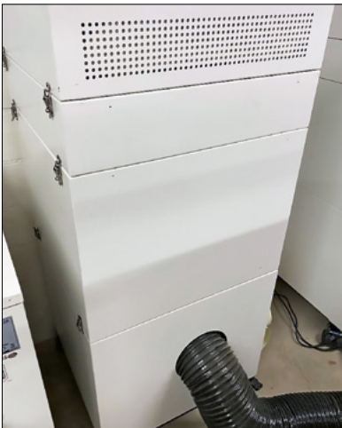
Absaugturm mit 3-fach-Filterung
