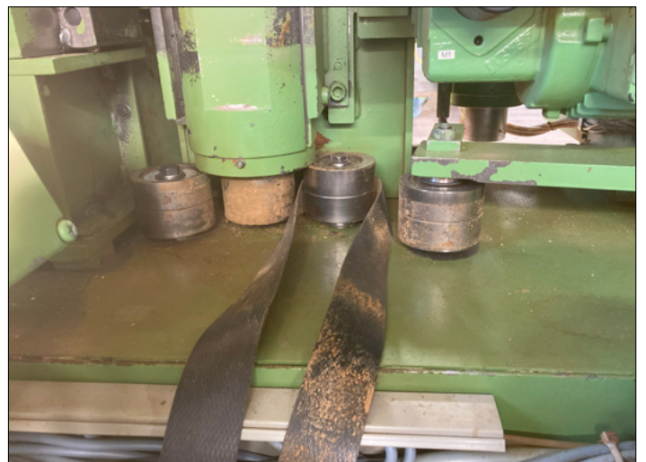
Umlenkrollen werden neu gelagert
