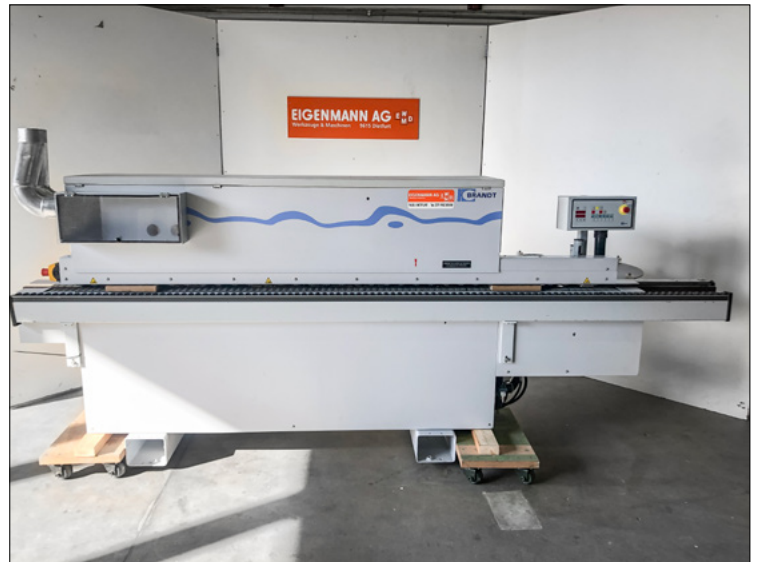
Kantenanleimmaschine Brandt KDF 340
