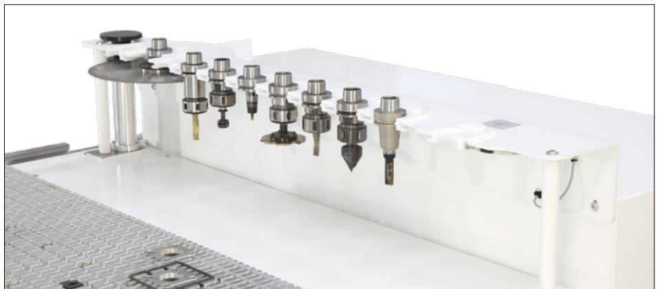
10-fach-Linearwechsler Zusätzliches Werkzeugwechselmagazin mit 10 Plätzen und integriertem Werkzeugübergabepplatz, seitlich rechts angebaut
