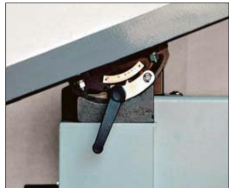
Tischschwenkeinrichtung stufenlos bis 45°
