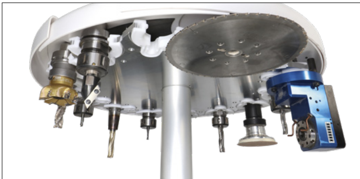
14-fach-Tellerwechsler in X-Richtung, mitfahrend
