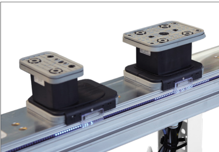
LED Positionsanzeigesystem für Konsolen und Vakuumspanner
