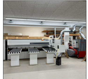
Horizontale Plattenaufteilsäge HOMAG B-130
