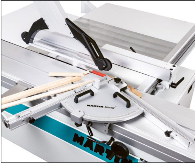
MitreX mit analoger Winkelanzeige
