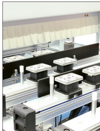
Werkstücke einlegehilfen Robuste Einlegehilfen zum Belegen schwerer Werkstücke mit 2 Pneumatikzylindern
