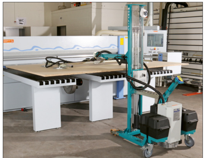
Die Platte lässt sich elektrisch abschwenken
