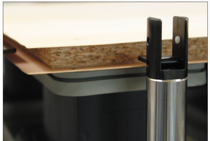
Anschläge bei Deckschichtüberstand
