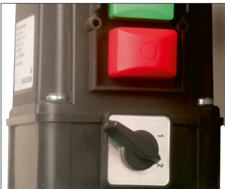
Motor mit zwei Drehzahlen
