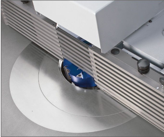
Elektromotorisch positionierbare Tischöffnung
