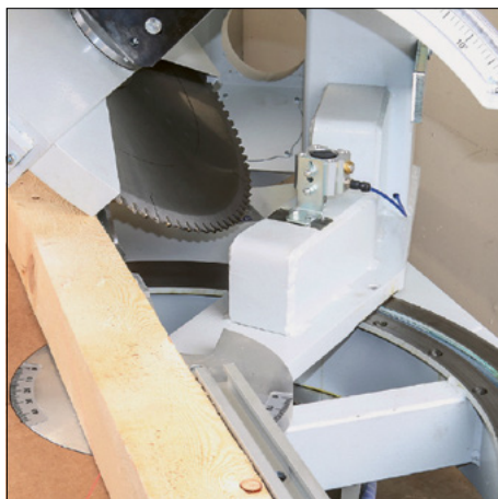
Schwenkung +60° bis –45° stufenlos mit Fixraster
