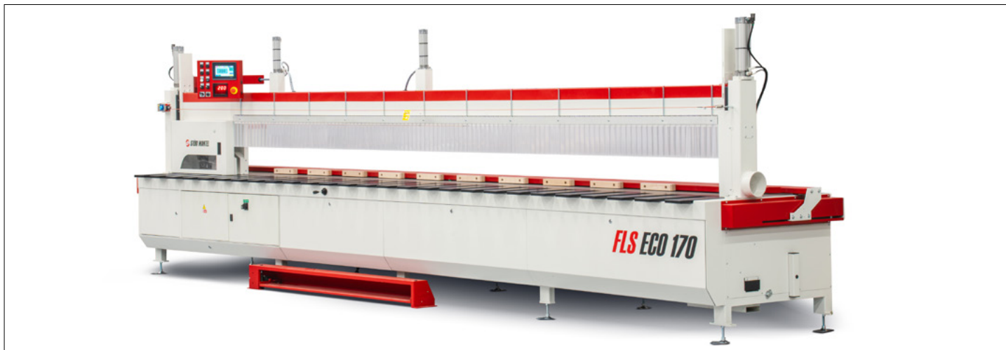
Längskreissäge Störi Mantel FLS ECO 170 Swissline
