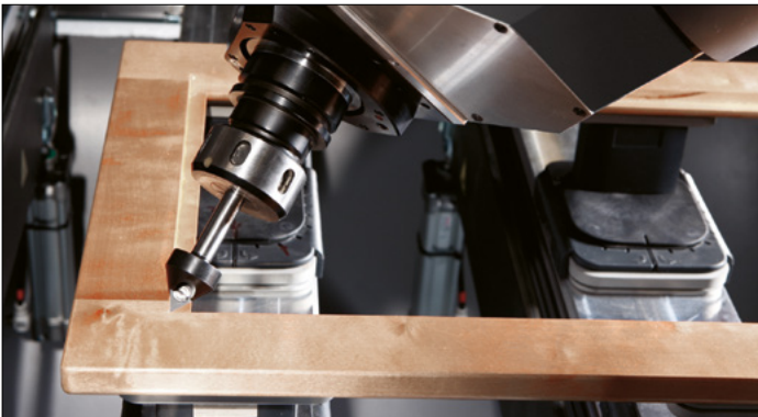
Eckiges Ausspitzen einer Glasfalz-Ecke
