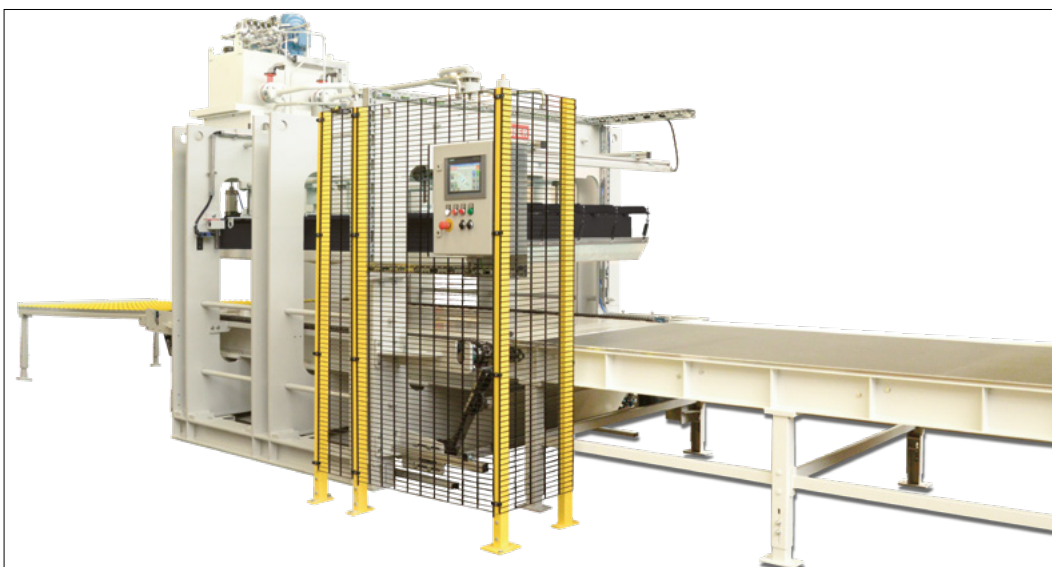
Kurztakt-Durchlaufpresse Höfer HDP, längsbeschickt
