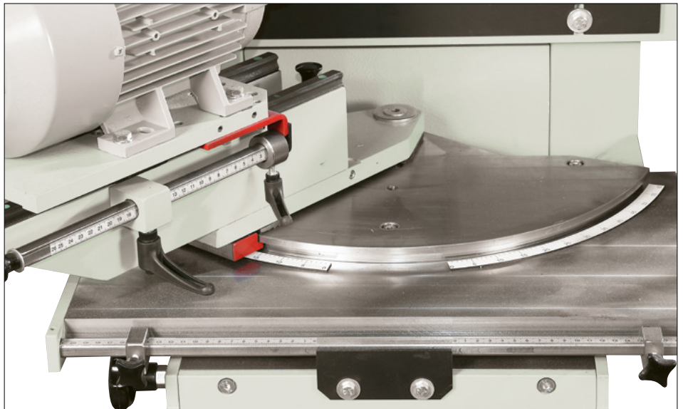
Schwenkvorrichtung zu Hess LLB 400
