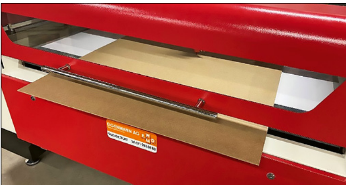
Unbeschränkte Werkstückgröße in Y-Richtung bis zu einer Werkstückdicke von 70 mm
