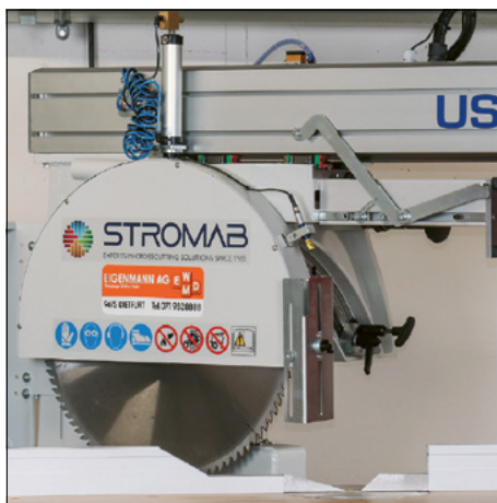
Schutzhaube pneumatisch geöffnet
