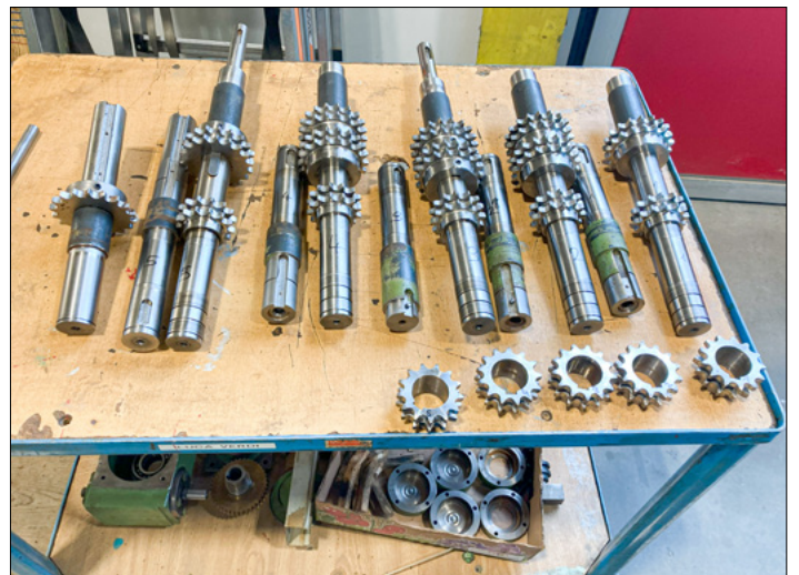
Alle Vorschubwellen werden überarbeitet und neu gelagert
