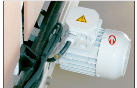
Sägerostverstellung über Elektromotor mit Überlastsicherung
