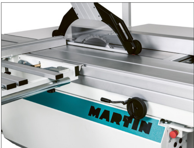
Parallelanschlag T66/T77 mit Handrad /T7741
