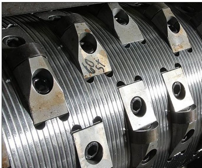
Rotor version V5 mit geschraubten Messertträgern
