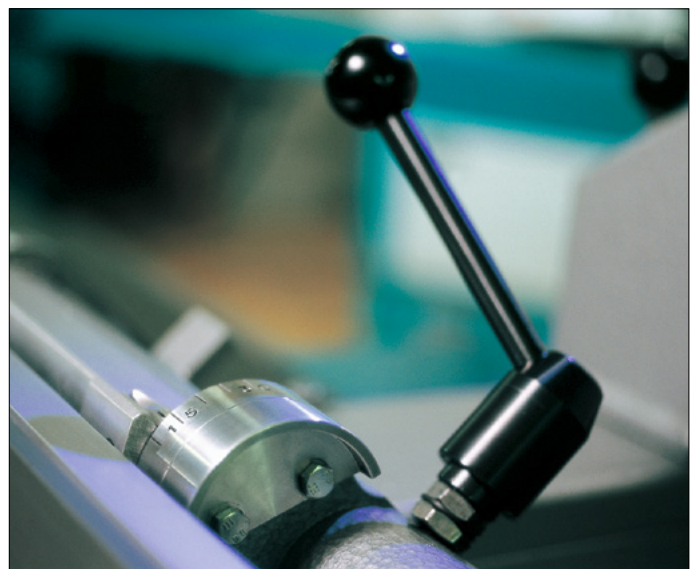
Einhandverstellung für die Anschlagneigung
