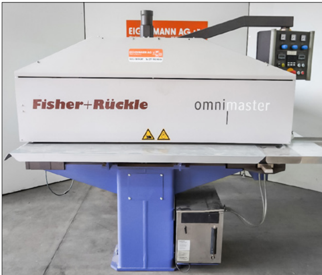
Furnierzusammensetzmaschine Fisher + Rückle Omnimaster 1200
