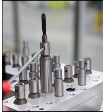
Weldon Wechselsystem für einen Bohrerwechsel mit Werkzeugen
