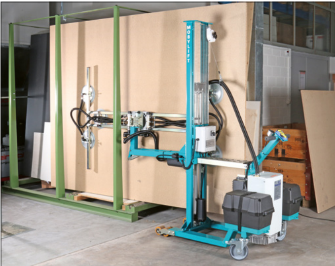
Entnahme einer Platte aus dem vertikalen Plattenlager
