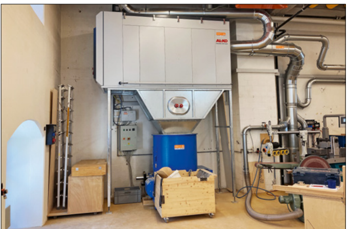
Montage einer Absauganlage mit Brikettierpresse
