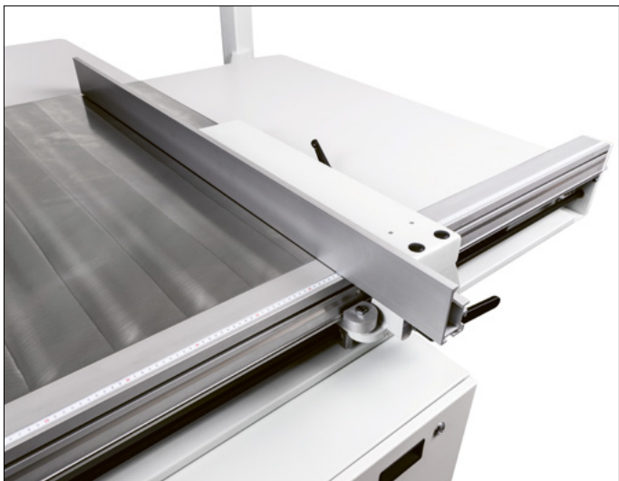
Parallelanschlag T66/T77, Bewegung von Hand nach Skala
