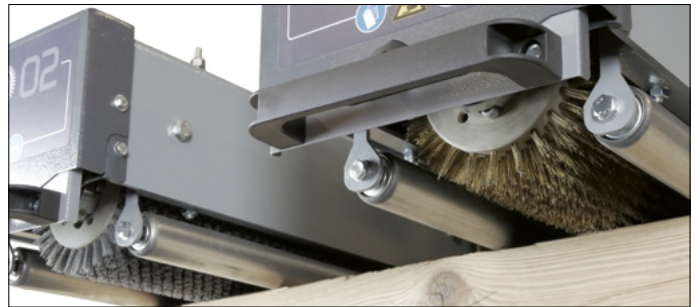
Zwei Bürstaggregate, erstes Aggregat mit Stahlbürste, zweites mit Siliziumkarbid
