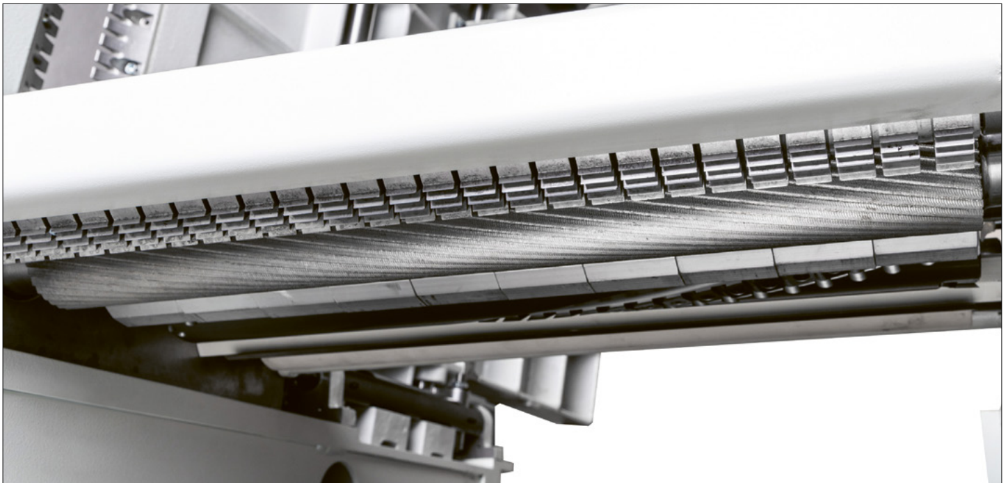
Spiraleinzugswalze mit Gliederdruckbalken
