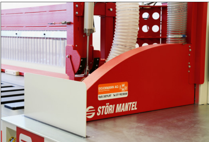
Schutzschild, pneumatisch ausgefahren
