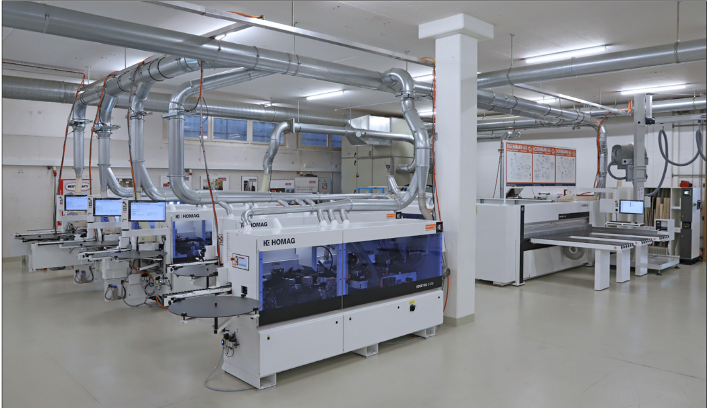
Kantentechnik HOMAG EDGESEQ und Plattenaufteiltechnik HOMAG SAWTEQ
