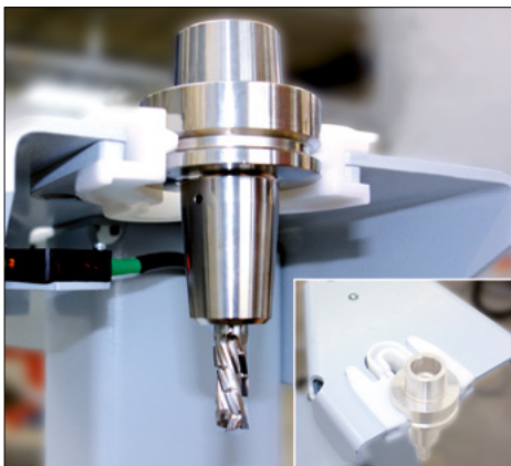
Werkzeugübergabepplatz – Sicheres und schnelles Beschicken des Werkzeugwechselmagazins – Hohe Sicherheit durch Sensorabfrage, ob der Werkzeugübergabepplatz frei oder belegt ist
