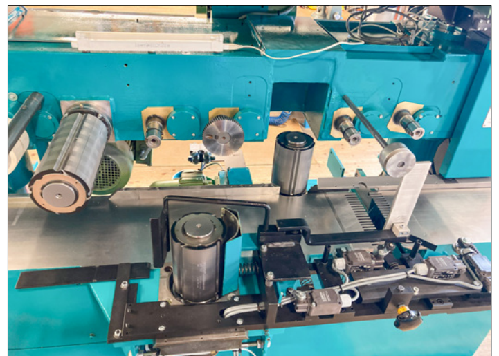
Verkabelung und Endschalter werden neu gemacht
