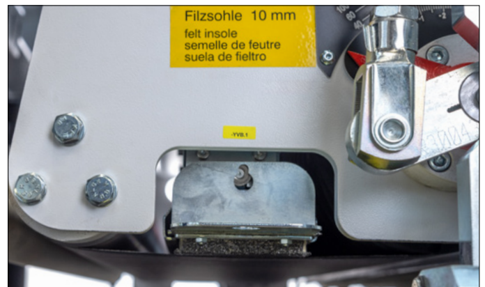
Kombiaggregat mit pneumatisch zustellbarer Schleifwalze und Segmentschleifschuh CSD
