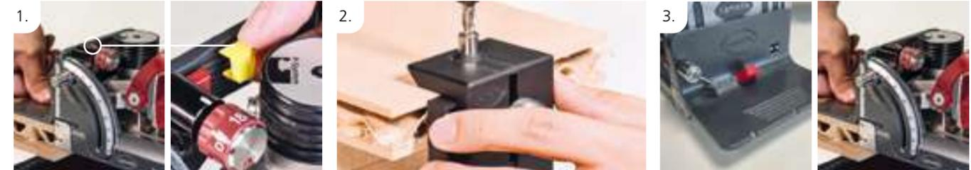
1. Mit dem LC P-16 Konfigurator die Höheneinstellung und den passenden LC P-16 Verbinder bestimmen. Mit Tiefeneinstellung P-18 und 2 mm Tiefenstelleraufsatz Nut fräsen (Frästiefe = 16 mm).
