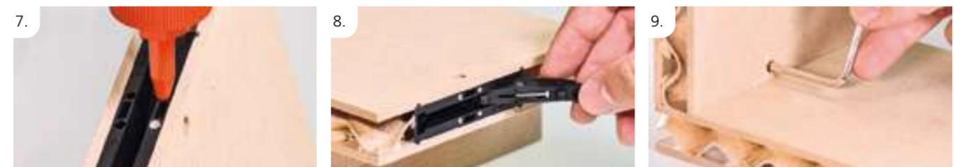
7. Beim LC P-16 x 17 und beim LC P-16 x 22 Leim durch die Leimkanäle auftragen.
