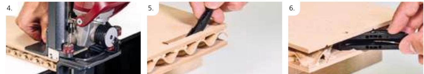
4. Mit Tiefeneinstellung P-10 und ohne Tiefenstelleraufsatz eine Fräsung in der Fläche vornehmen. Optional den zweiten Winkelanschlag für eine verbesserte Stabilität verwenden.
