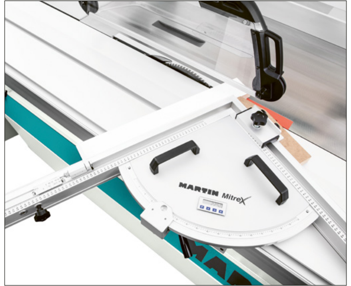
MitreX mit digitaler Winkelanzeige
