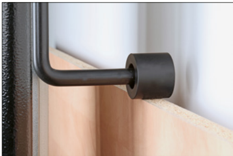
Streifenanschlag bis 580 mm für horizontale Schnitte
