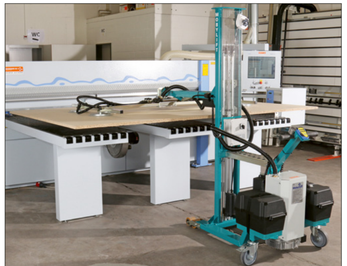
Die Platte lässt sich elektrisch abschwenken
