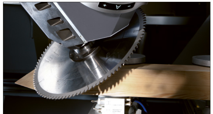
Schifterschnitt mit grosser Schnitttiefe für Rahmenteile
