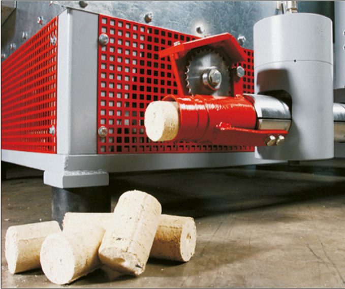
Zangenzyylinder mit Stranglängenüberwachung
