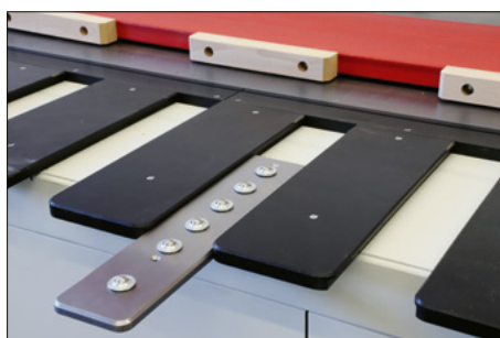
Metallauflegeplatten mit Kugelrollen
