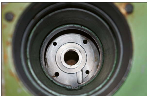
Pinolenführung gereinigt und poliert
