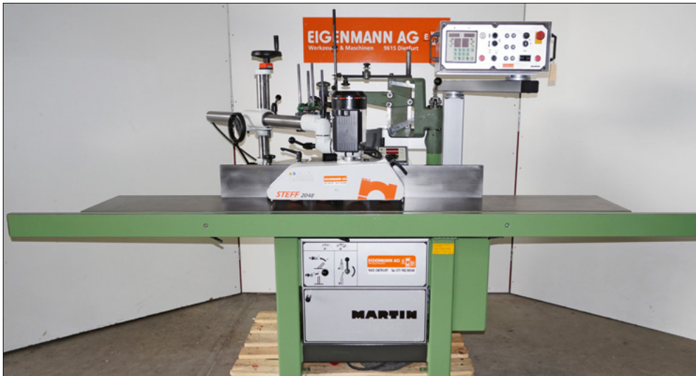
Kehlmaschine Martin T25 nach der Revision
