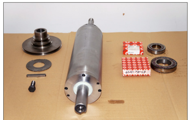
Fertig vormontierte Pinole mit neuen Lagern
