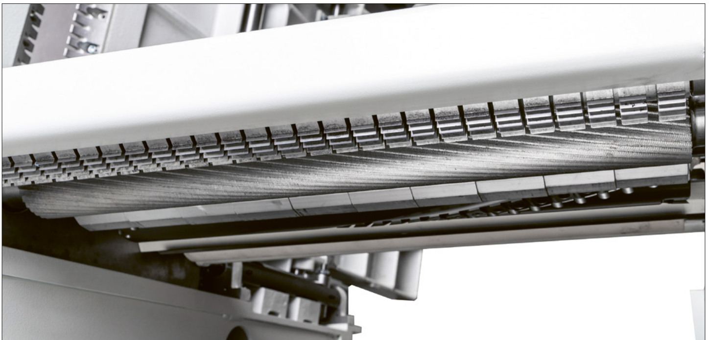
Spiraleinzugswalze mit Gliederdruckbalken
