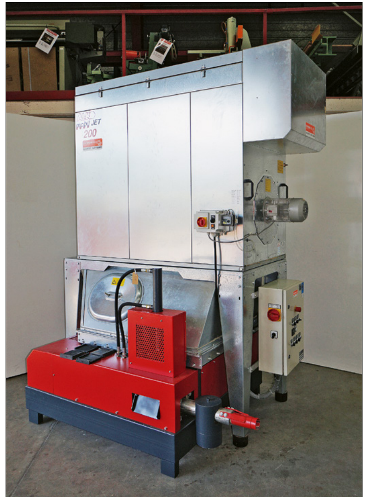
Brikettierpresse Weima TH 200 S mit AL-KO Mobil Jet 200
