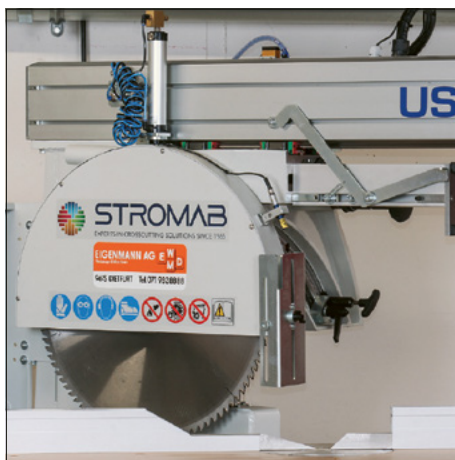
Schutzhaube pneumatisch geöffnet
