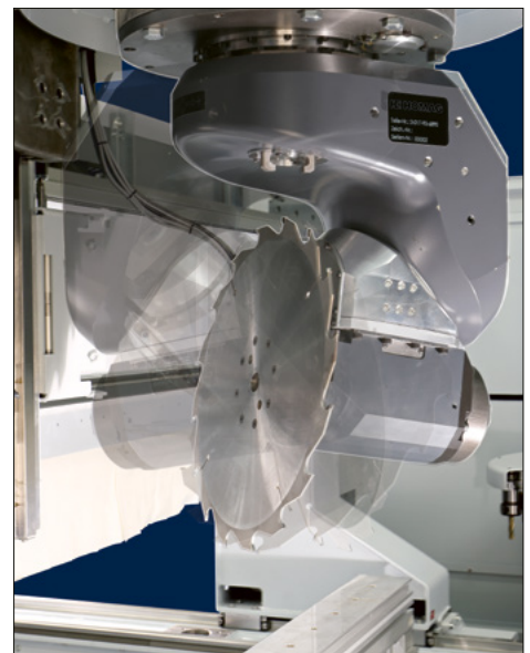
DRIVECS 5-Achs-Kopf Flüssigkeitsgekühlte Spindeln
