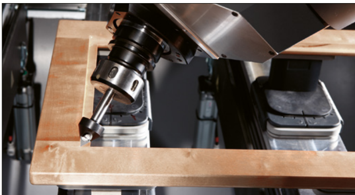
Eckiges Ausspitzen einer Glasfalz-Ecke
