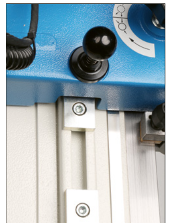
Fixpunkte für absolute Wiederholgenauigkeit
