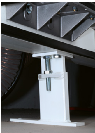
Fünf einzeln nivellierbare Standfüße
