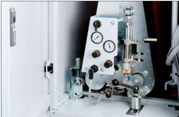
Bedienelemente auf der Bandwechselseite
