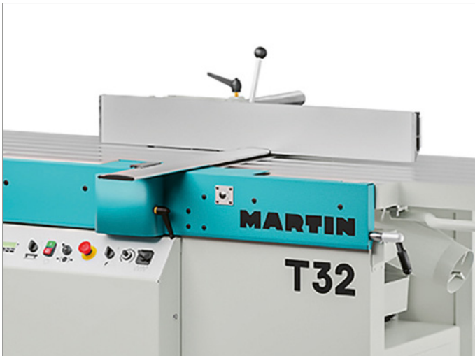
Abricht-/Dickenhobelmaschine Martin T32, gerüstet für den Abrichtbetrieb
