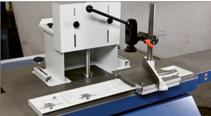
Zapfenschneid- und Schlitzapparat mit Schutzhaube
