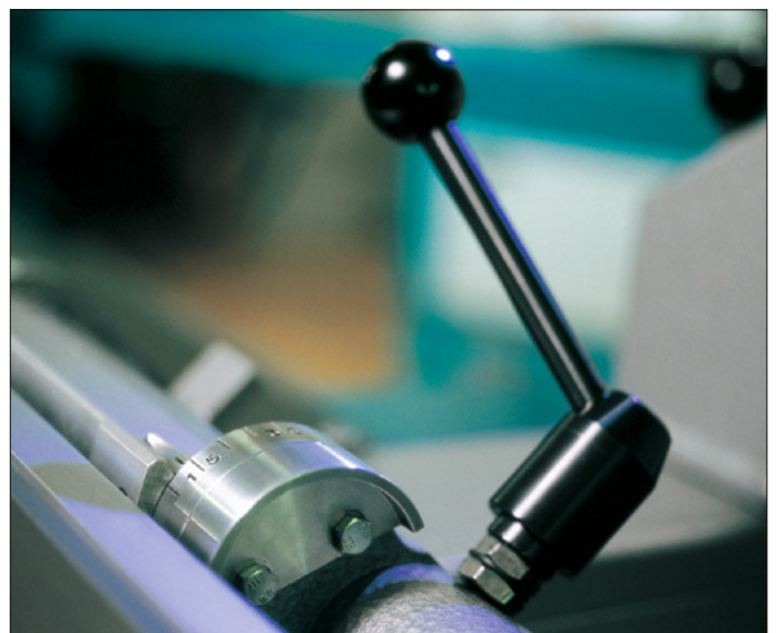
Einhandverstellung für die Anschlagneigung
