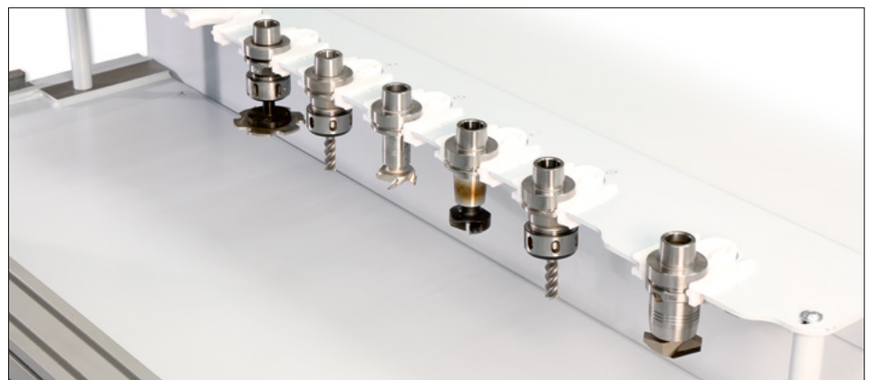
8-fach-Tellerwechsler In X-Richtung, mitfahrend
