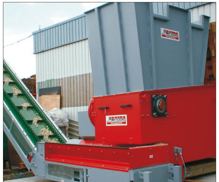
Austragung mit Transportband
