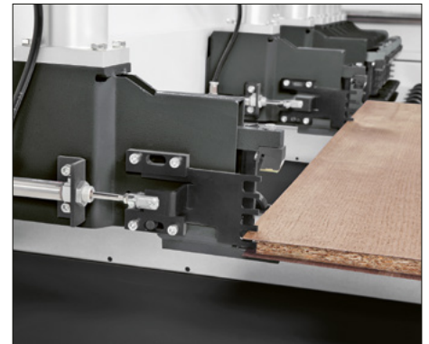
Besäumanschläge für Materialien mit überstehenden Deckschichten
