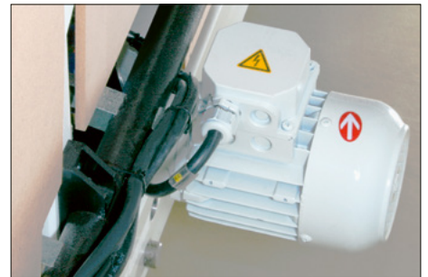
Sägerostverstellung über Elektromotor mit Überlastsicherung
