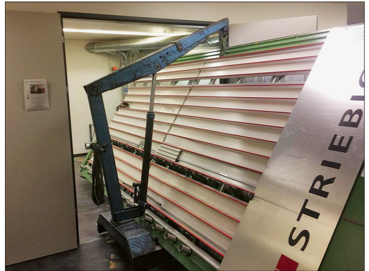
Einbringung einer Breitbandschleifmaschine HOMAG SANDTEQ über ein dafür geöffnetes Werkstattdach. Es wurde ein externer Pneukran für die Einbringung beim Kunden hinzu gezogen.
