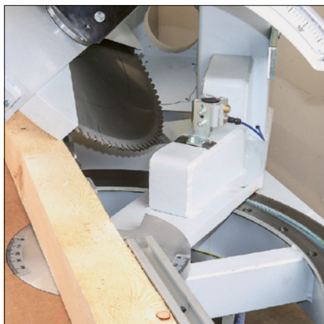
Schwenkung +60° bis –45° stufenlos mit Fixraster
