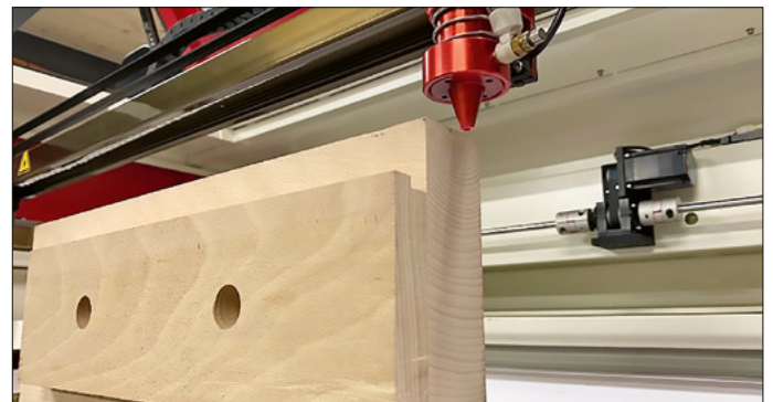
Maximale Werkstückdicke von 150 mm
