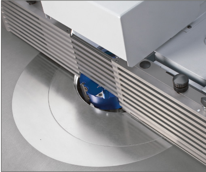
Elektromotorisch positionierbare Tischöffnung
