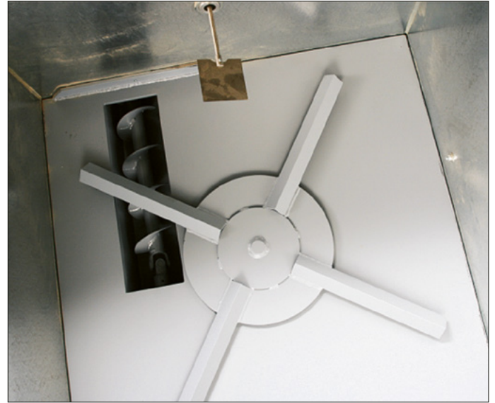
Rührwerk mit Schneckenaustragung
