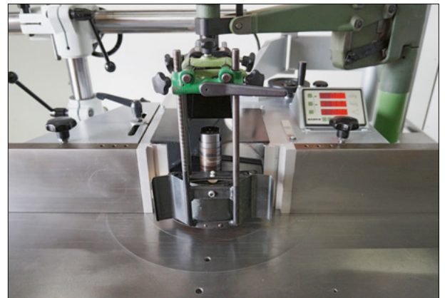
Kehlanschlag revidiert mit neuer Digitalanzeige
