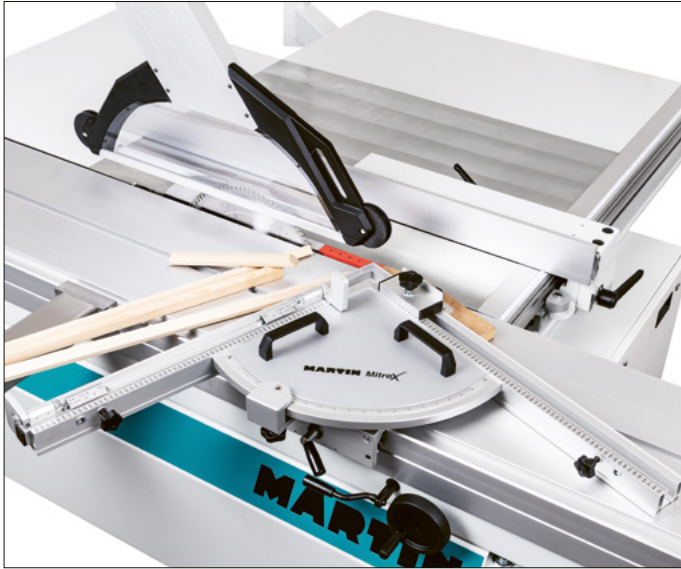
MitreX mit analoger Winkelanzeige
