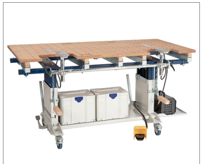
Supporter Beck AM 500 FLEXX mit auf Arbeitsposition aufgeklappter Buche-Multiplex-Lochplatte
