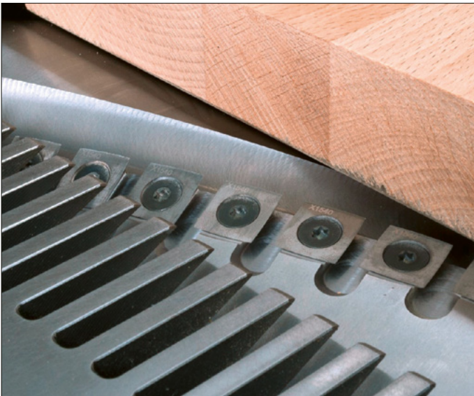
Vollstahl-Messerwelle Xplane mit 3 spiralförmigen Messerreihen
