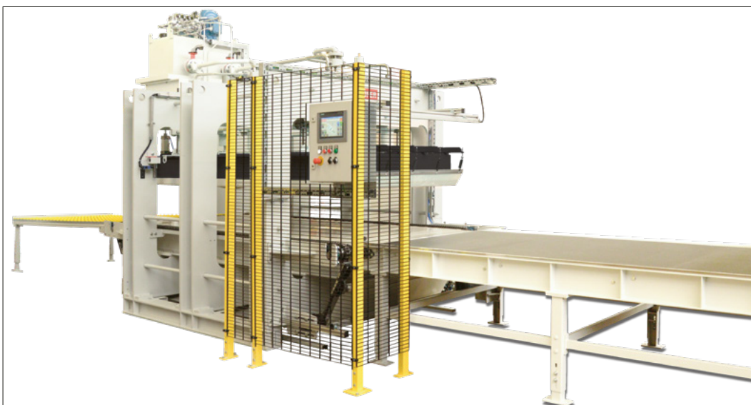
Kurztakt-Durchlaufpresse Höfer HDP, längsbeschickt
