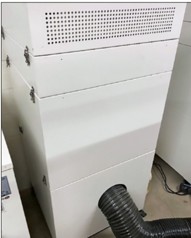
Absaugturm mit 3-fach-Filterung
