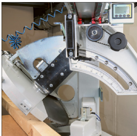
Neigung bis 45° stufenlos mit Fixraster
