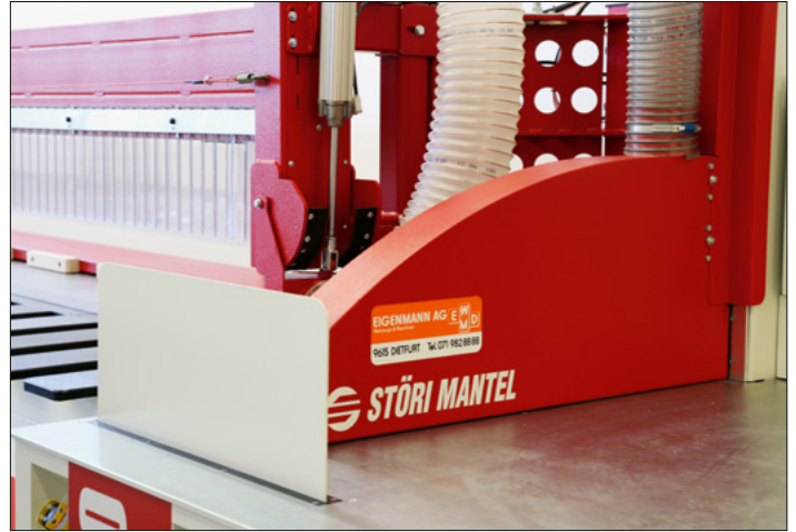
Schutzschild, pneumatisch ausgefahren
