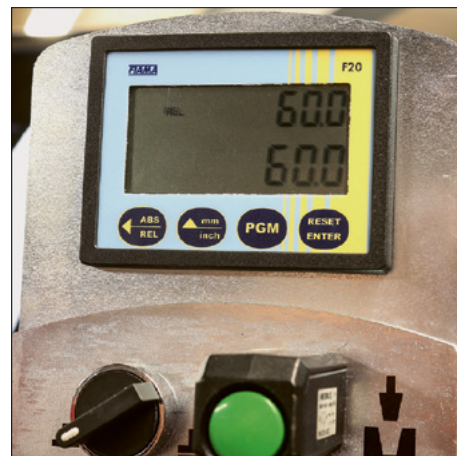
Digitalanzeigen für Neigung und Schwenkung
