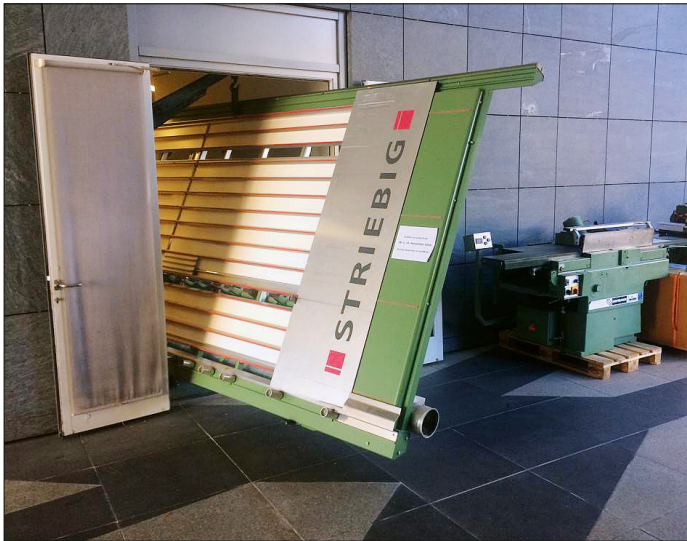
Ausbringung einer vertikalen Plattensäge durch ein schmales Tor
