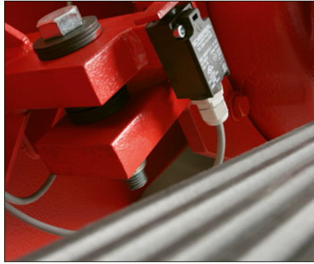
Sicherheitspaket mit Getriebeendschalter und Reversierzähler
