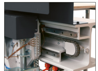
Massive Konstruktion mit H-Träger
