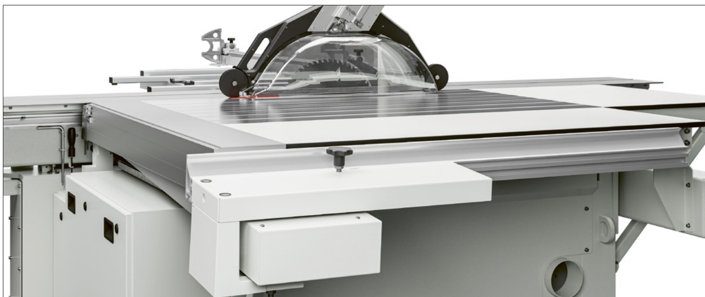
Parallelanschlag T77, elektronisch gesteuert und in Endposition absenkbar/T7743
