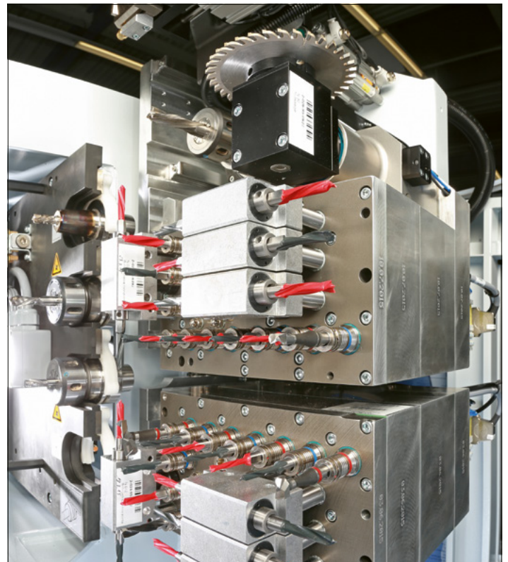
Konfiguration 36-Spindler mit doppeltem Bohrkopf
