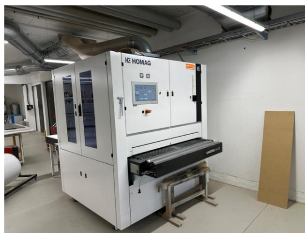
Neue Breitbandschleifmaschine von HOMAG
