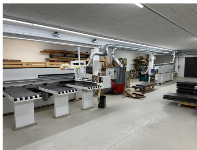
Neue Kantenleimmaschine und liegende Plattenzuschnittsäge von HOMAG
