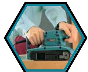
Effizientes Schleifen, mit elektronisch regelbarer Geschwindigkeit.
