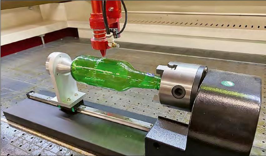
Rundgravurvorrichtung für runde Werkstücke bis zu einem Durchmesser von 66 mm
