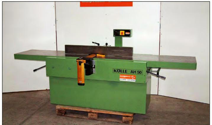
Abrichthobelmaschine Kölle AH 50
