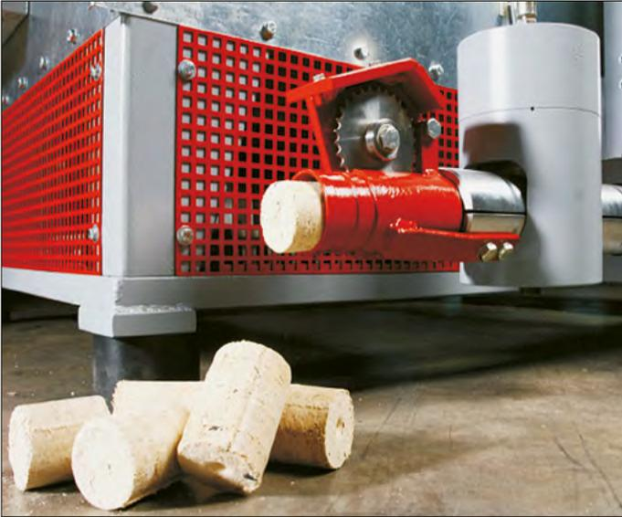
Zangenzylinder mit Stranglängenüberwachung
