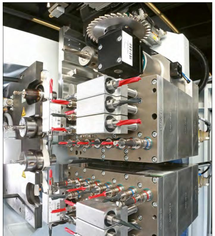
Konfiguration 36-Spindler mit doppeltem Bohrkopf
