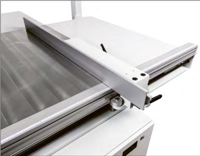
Parallelanschlag T66/T77, Bewegung von Hand nach Skala
