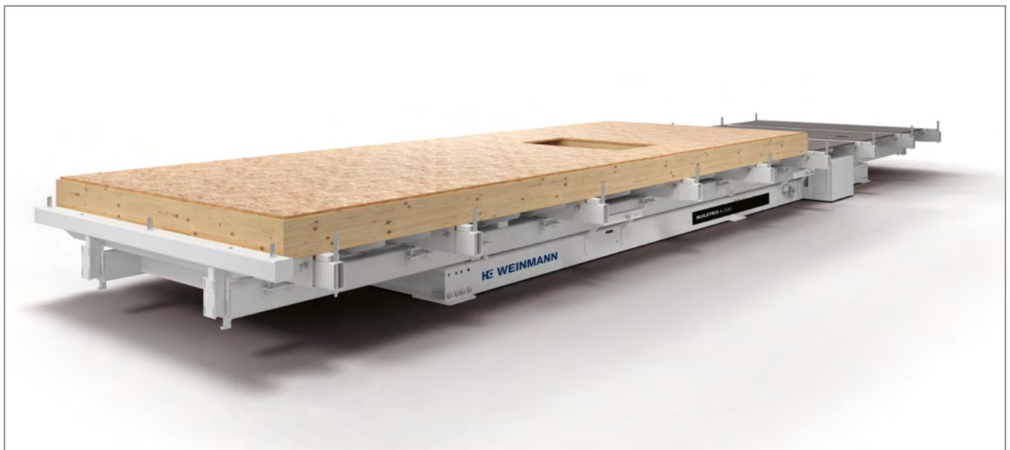
Zimmermeister – Tische BUILDTEQ A-500 / A-530 – Universell einsetzbar; Für das Herstellen von Wand-, Giebel-, Dach- und Decken-Elementen sowie Fachwerkwänden und Dachgauben sind diese Zimmermeister-Tische optimal geeignet. Die integrierte Technik gewährleistet eine hohe Masshaltigkeit und Winkelgenauigkeit. Mit den verfügbaren Optionen können Sie die Zimmermeister-Tische zusätzlich ausstatten und so ideal an Ihre Anforderungen anpassen.
