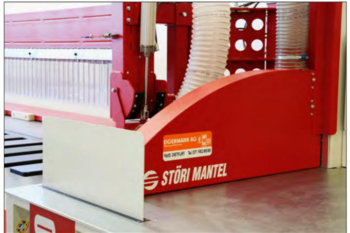
Schutzschild, pneumatisch ausgefahren
