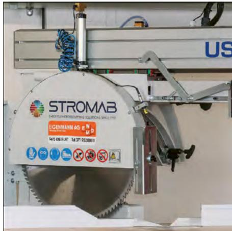
Schutzhaube pneumatisch geöffnet
