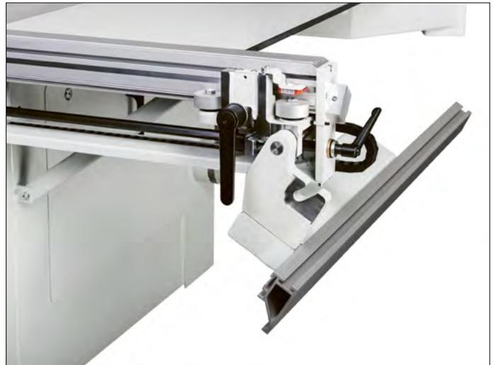
Parallelanschlag T66/T77, motorisch angetrieben, abklappbar / T7742
