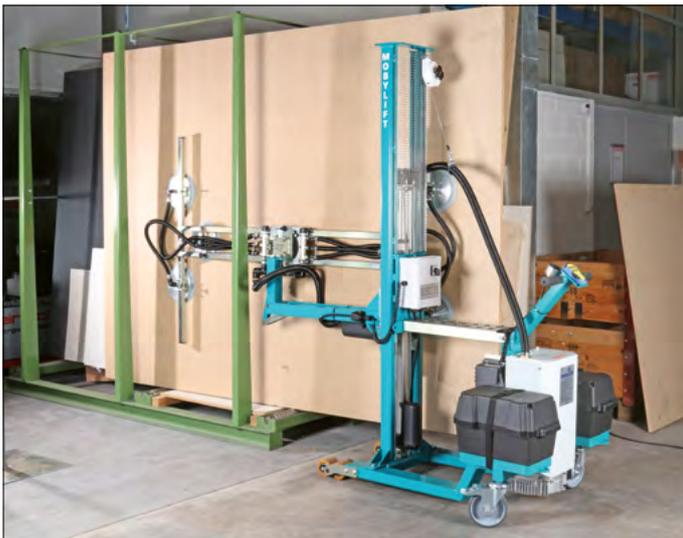
*Entnahme einer Platte aus dem vertikalen Plattenlager*
