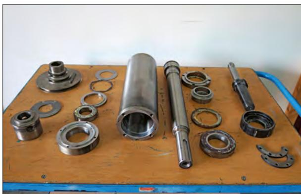
*Zerlegte Kehlspindel mit Pinole*
