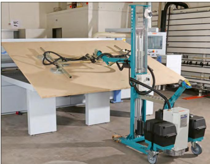
*Beschickung einer horizontalen Plattensäge*
