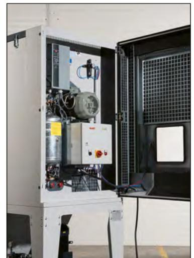
Steuerung mit FU und Löscheinrichtung
