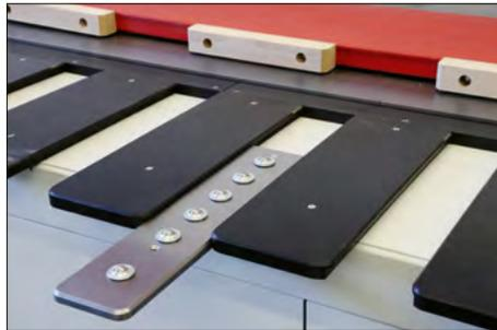
*Metallauflegeplatten mit Kugelrollen*
