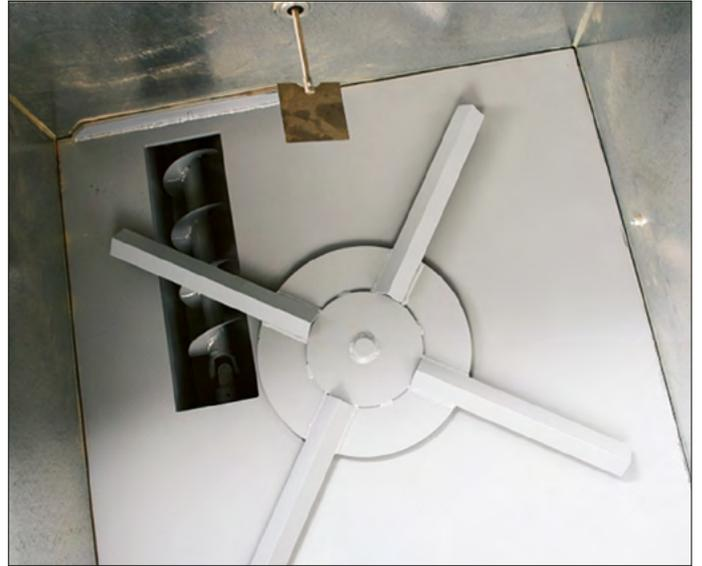
Rührwerk mit Schneckenaustragung
