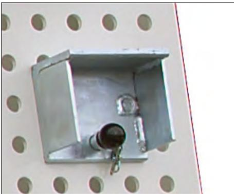
*Einzelgegenlager, schwenkbar, mit Magnetfeststellung*
