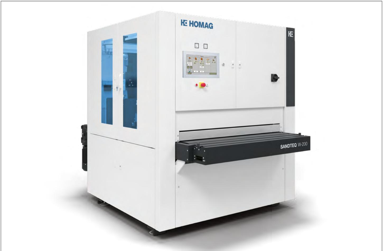
Breitbandschleifmaschine HOMAG SANDTEQ W-200 Modell SWT 225
