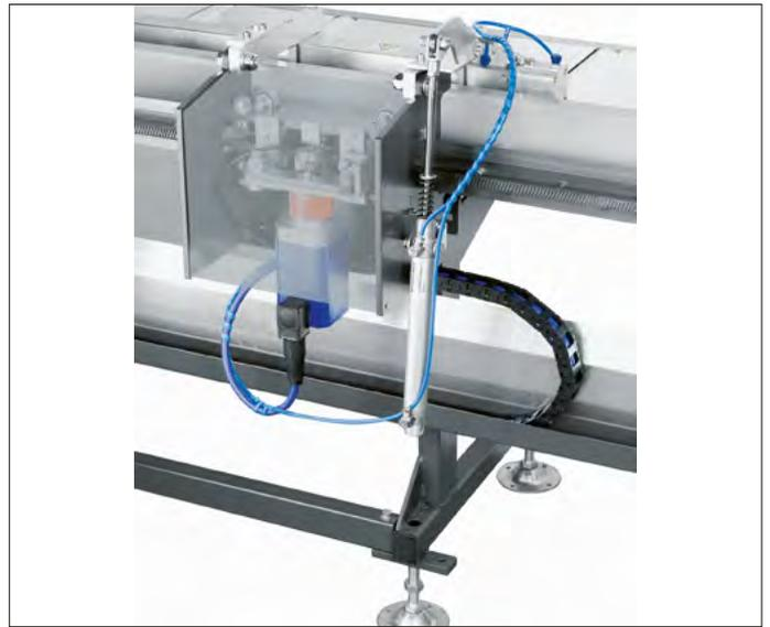
*Anschlag mit Servomotor positionierbar
