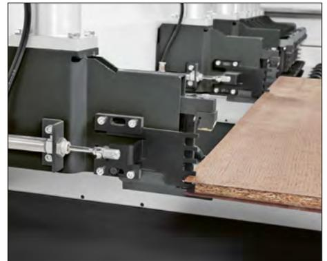
*Besäumanschläge für Materialien mit überstehenden Deckschichten*
