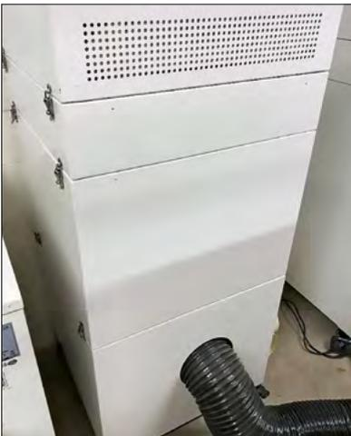
Absaugturm mit 3-fach-Filterung
