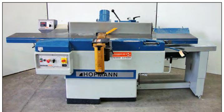
Abricht- Dickenhobelmaschine Hofmann AD 514
