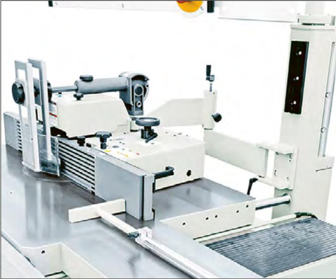
*Wegschwenkvorrichtung für den Fräsanschlag*
