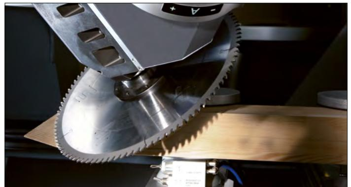
Schifterschnitt mit grosser Schnitttiefe für Rahmenteile
