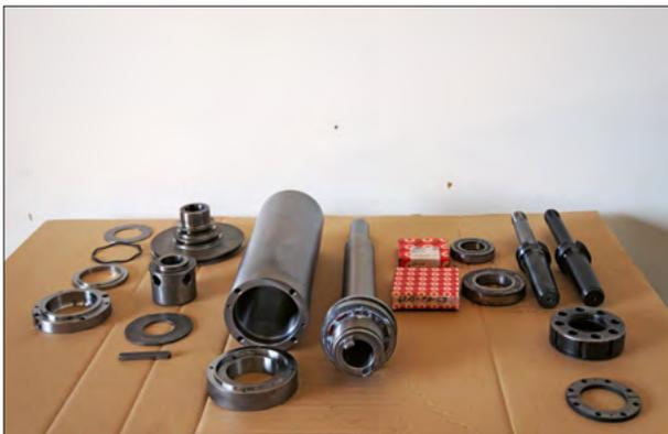
*Ersatzteile der Kehlspindel*
