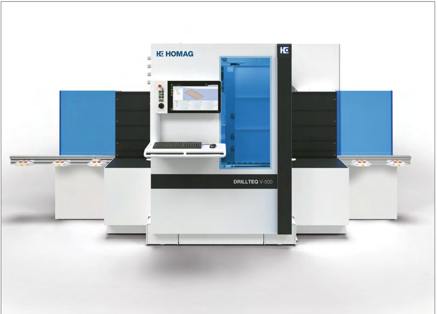
Vertikales CNC-Bearbeitungszentrum HOMAG DRILLTEQ V-500
