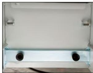
Vakuumstutzen für Spänecontainer
