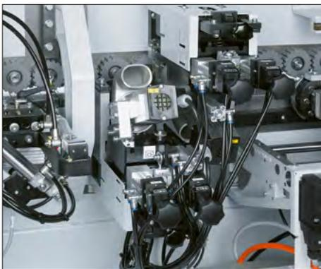
Fräsaggregat mit pneumatischer 3-Punkt-Verstellung
