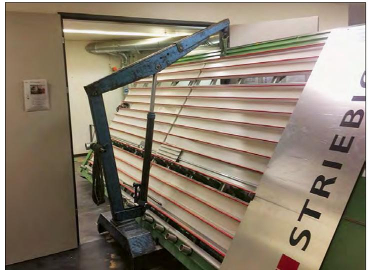
Ausbringung einer vertikalen Plattensäge durch ein schmales Tor
