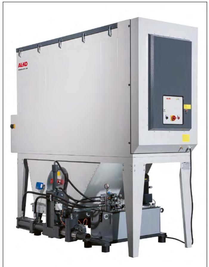
*Absauggerät AL-KO 350 P-BP mit Brikettierpresse in Kompaktbauweise*
