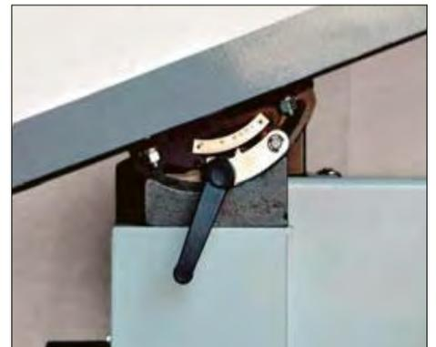
*Tischschwenkeinrichtung stufenlos bis 45°*
