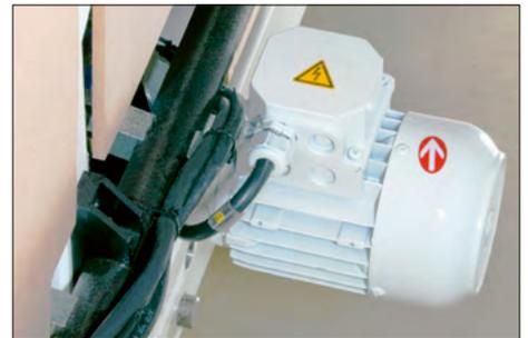
Sägerostverstellung über Elektromotor mit Überlastsicherung
