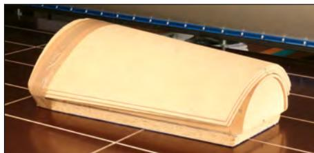
Freiform unter Vakuum verleimt
