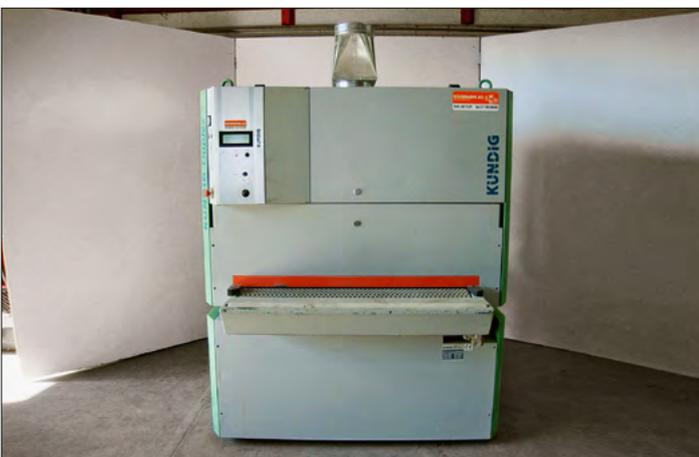
Breitbandschleifmaschine Kündig Duplex 1100
