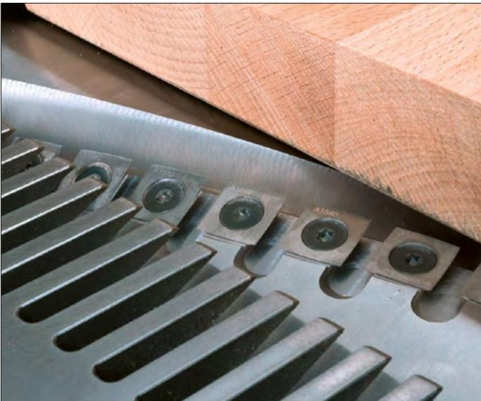
Vollstahl-Messerwelle Xplane mit 3 spiralförmigen
