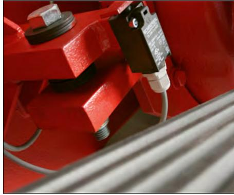
Sicherheitspaket mit Getriebeendschalter und Reversierzähler
