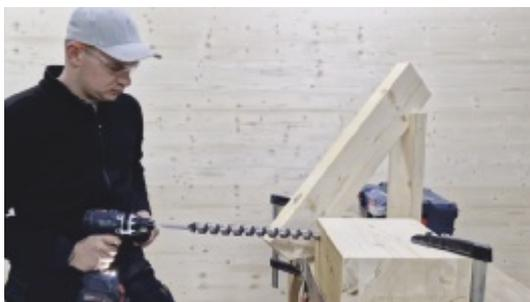
„Dank der Winkelerkennung zeigt einem der Akku-Schrauber direkt beim Bohren oder Schrauben am Dach an, ob der Winkel passt. Mit 150 Nm ist er der grösste und leistungsstärkste Akku-Bohrschrauber, den Bosch im Sortiment hat.“
