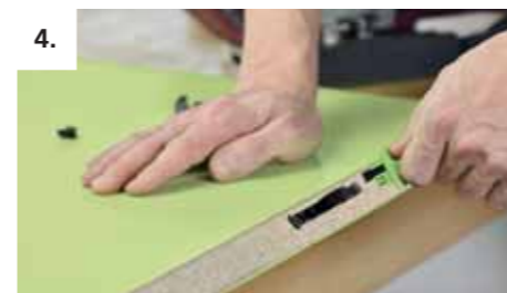
4. Vorspann-Clip eindrücken zum einfacheren Zusammenfügen der Bauteile.
