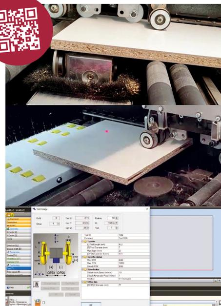
Die Programmierung für die Profalnuten erfolgt in der Vitap-Software TPA, dafür wurden ein zusätzliches Unterprogramm und eine Instruktion für die Umsetzung erstellt.
