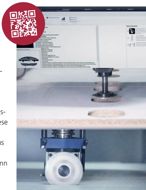
möglichkeiten 90° stumpf oder 2 × 45° Gehrung gemäss Einbaulogik von Lamello. Für individuelle Fälle hat Format4 ein Makro entwickelt, welches komplett frei im Raum platzierbar ist, speziell bei Freiform teilen ermöglicht dieses fast grenzenlose Möglichkeiten. Im Video sehen Sie die **Format4 profit H80**.
