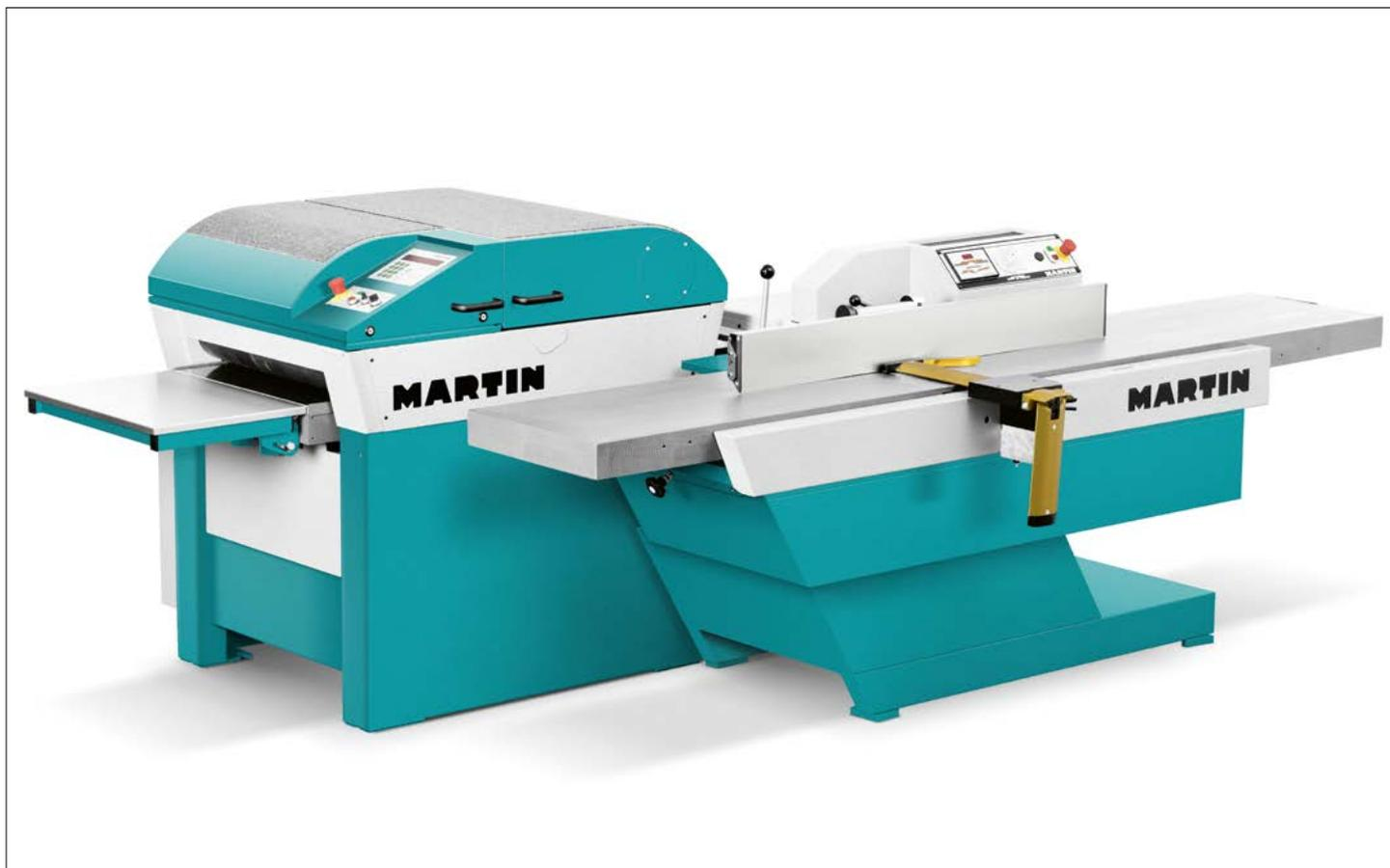
*Kombination Abricht- und Dickenhobelmaschine Martin T54/IT45*
