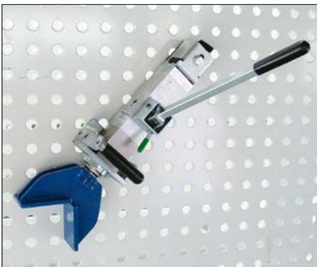
*Hydraulik-Pressaggregat, schwenkbar, mit Eckdruckstück 90°*
