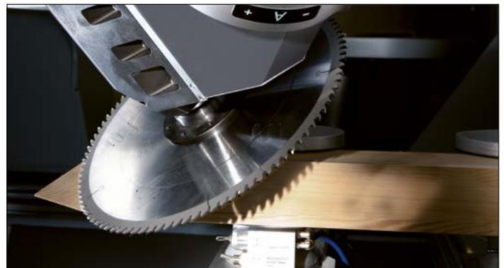
Schifterschnitt mit grosser Schnitttiefe für Rahmenteile
