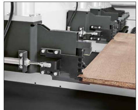
*Besäumanschläge für Materialien mit überstehenden Deckschichten*
