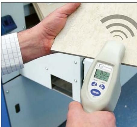
*Dickenmessgerät mit Funkübertragung*
