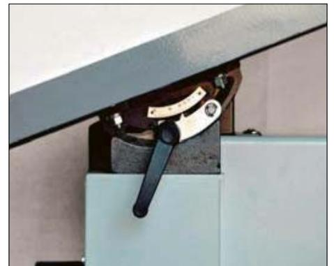
*Tischschwenkeinrichtung stufenlos bis 45°*
