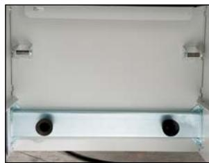
Vakuumstutzen für Spänecontainer
