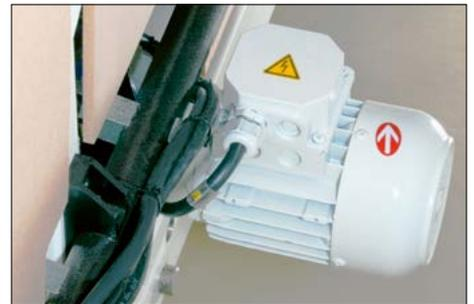
Sägerostverstellung über Elektromotor mit Überlastsicherung
