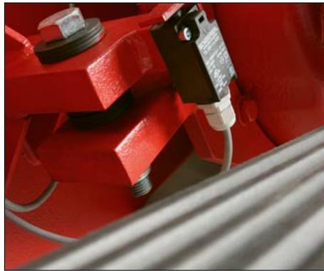
Sicherheitspaket mit Getriebeendschalter und Reversierzähler
