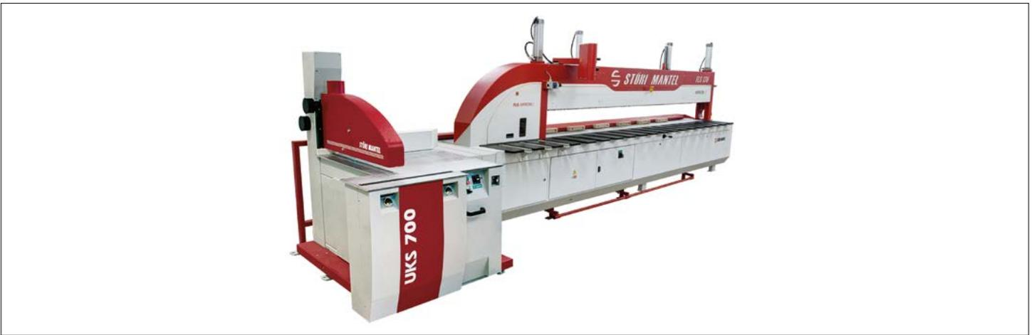
Längskreissäge Störi Mantel in Kombination mit Kappsäge
