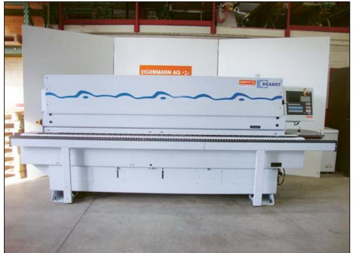
Kantenanleimmaschine Brandt Optimat KDF 530 C
