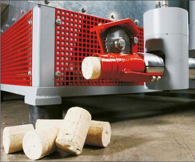
Zangenzylinder mit Stranglängenüberwachung
