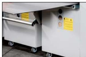
Absperrblech für Spänecontainer
