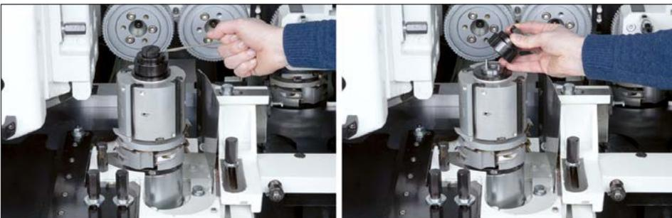
*Einfacher Werkzeugwechsel mit ProLock-Spindelklemmung*
