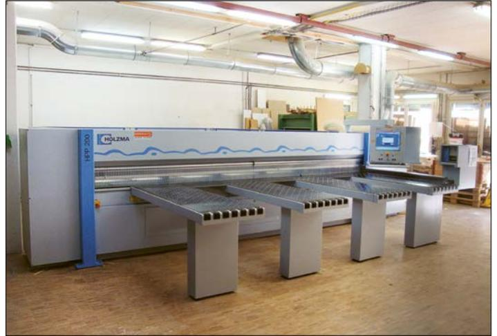
Horizontale Plattenaufteilsäge Holzma HPP 200
