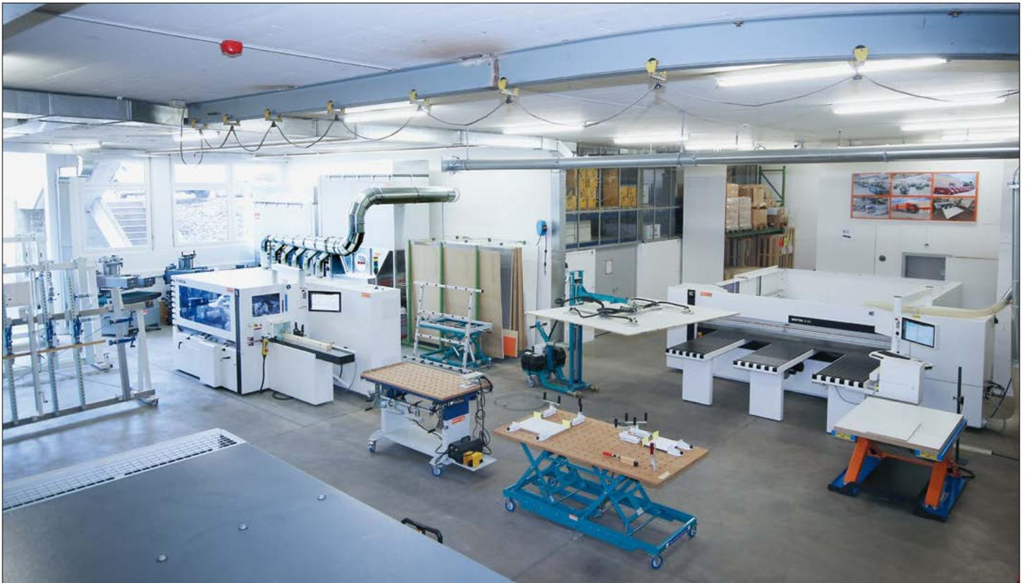
*Vierseitenhobelmaschine und horizontale Plattenaufteilsäge von HOMAG*
