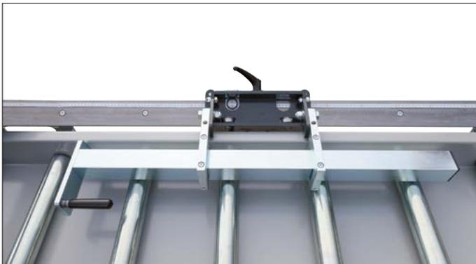
Manuell verstellbarer Anschlagwagen mit analogem Messsystem und Ableselupe
