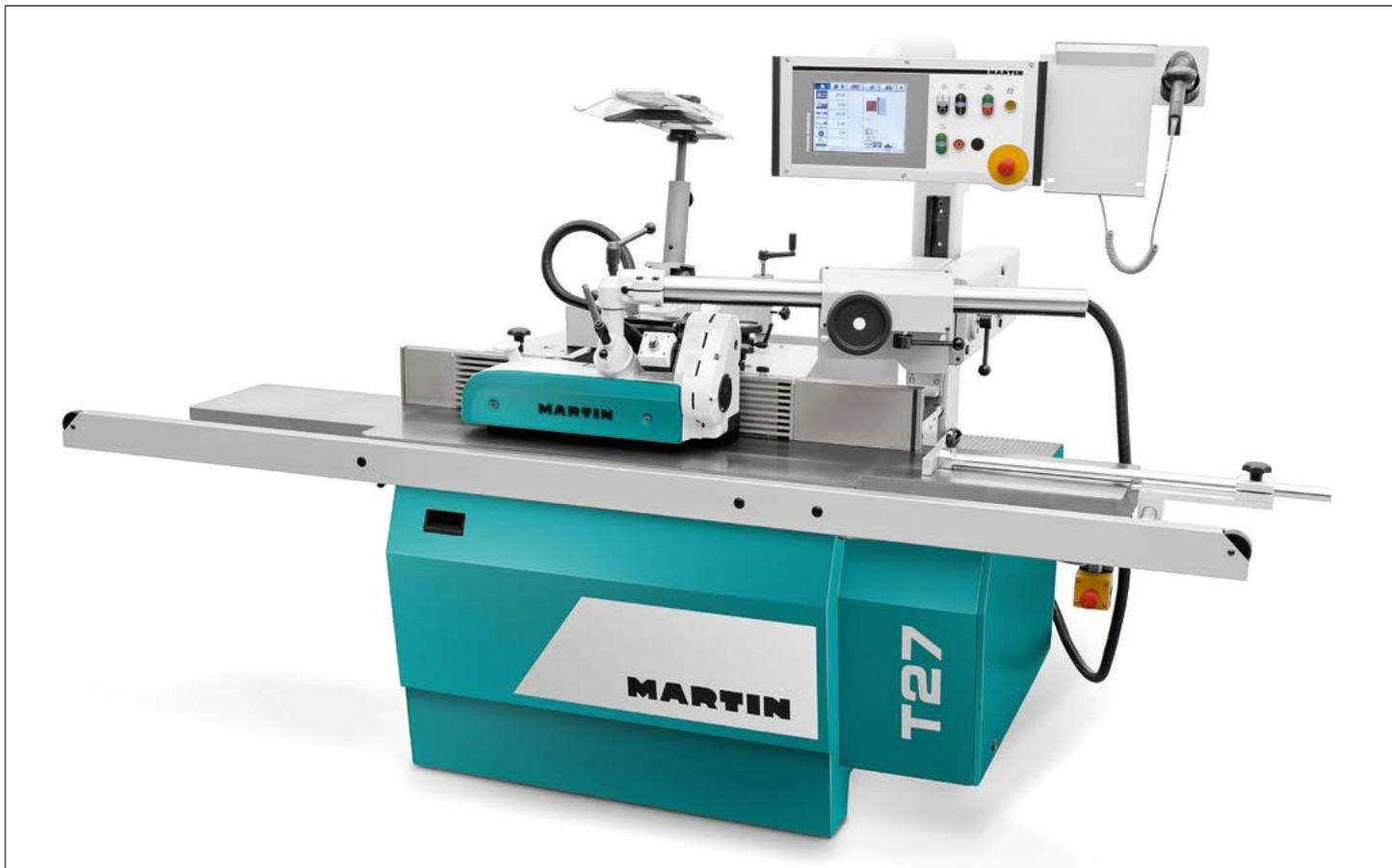
Kehlmaschine Martin T27 Flex, beidseitig 46° schwenkbar mit 6 gesteuerten Achsen
