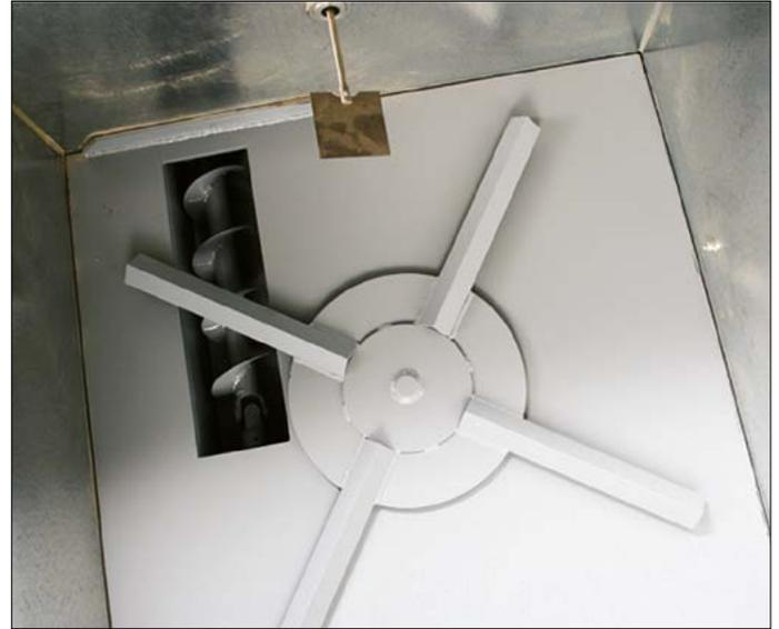
Rührwerk mit Schneckenaustragung
