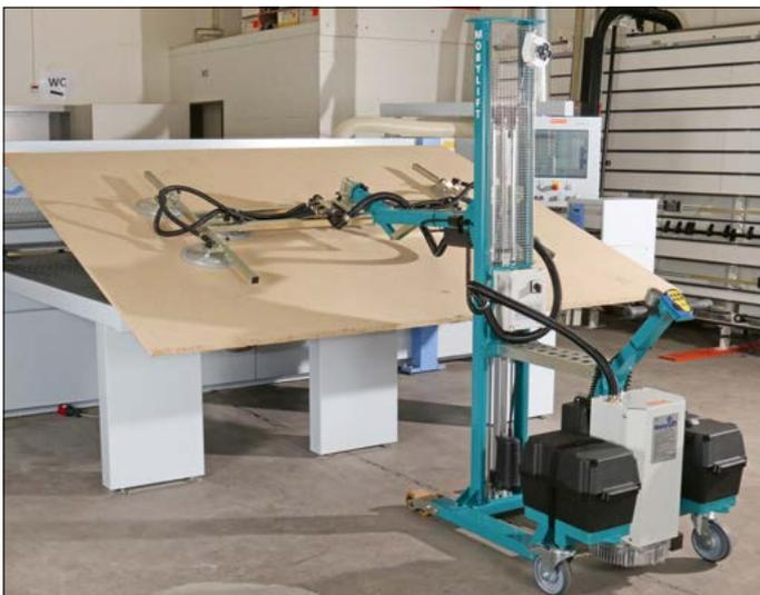
*Beschickung einer horizontalen Plattensäge, die Platte lässt sich elektrisch abschwenken*
