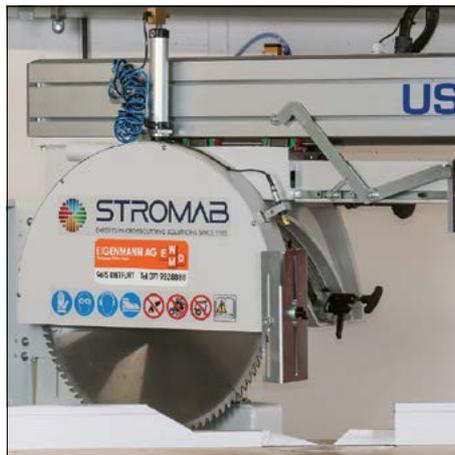
Schutzhaube pneumatisch geöffnet
