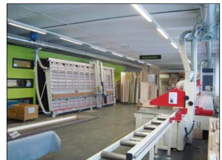
Montierte Zuschnittanlagen für Platten und Massivholz
