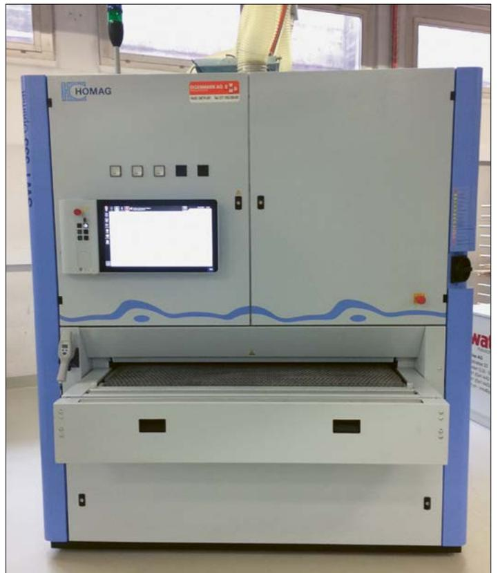
Breitbandschleifmaschine Homag Optimat SWT 335 QCH
