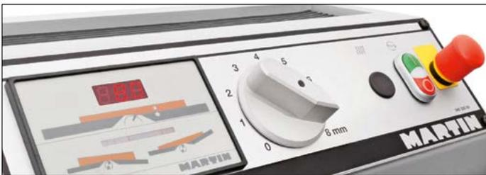
Bedienpult kombiniert und mitfahrend mit Abrichtanschlag
