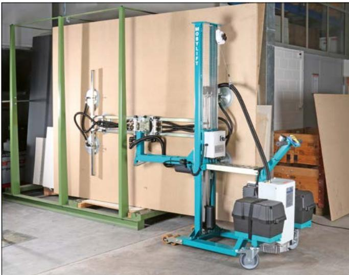
*Entnahme einer Platte aus dem vertikalen Plattenlager*
