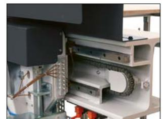
Massive Konstruktion mit H-Träger
