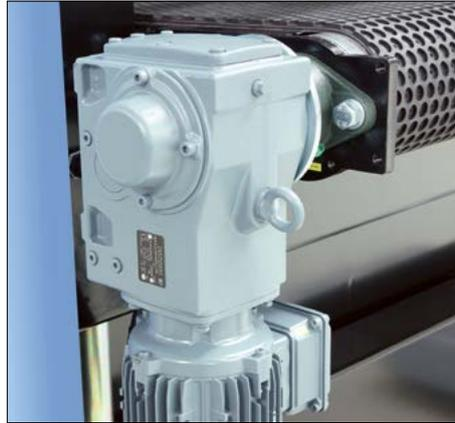
*Stufenlose Regelung der Vorschubgeschwindigkeit*
