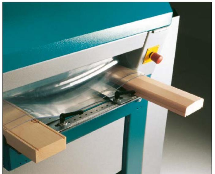
*Hobeln unterschiedlicher Profile in einem Durchgang*
