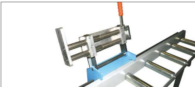
*Manuell wegschwenkbarer Materialanschlag gefedert*
