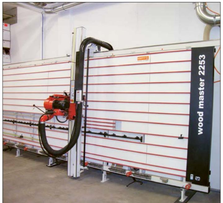
Vertikale Plattensäge Putsch Meniconi wood master 2253
