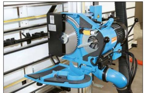
– Schallgedämmtes Gehäuse mit integrierter Absaugung
