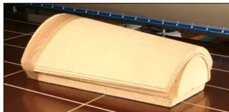
Freiform unter Vakuum verleimt
