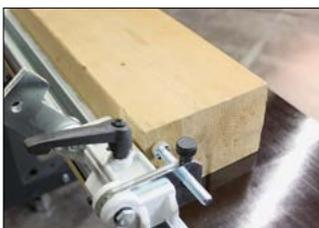
Das 3 Meter lange Anschlagprofil mit mm-Skala sowie der Längensschlag ermöglichen präzises Positionieren der Werkstücke
