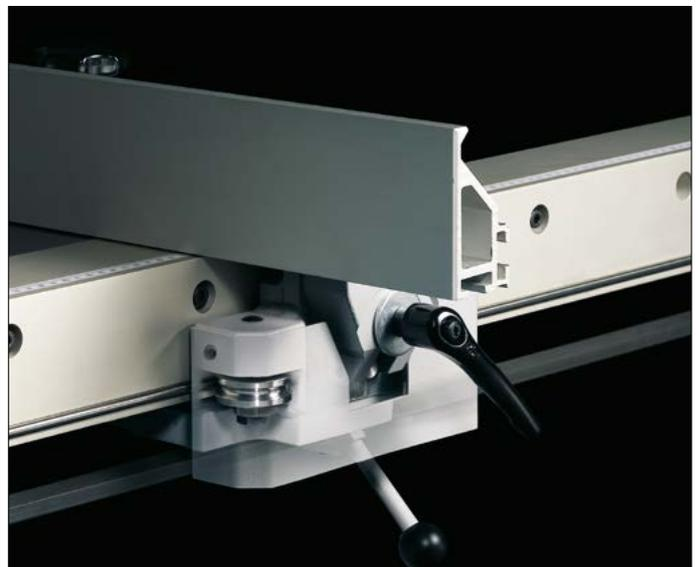
*Parallelanschlag mit Rillenkugellager geführt*
