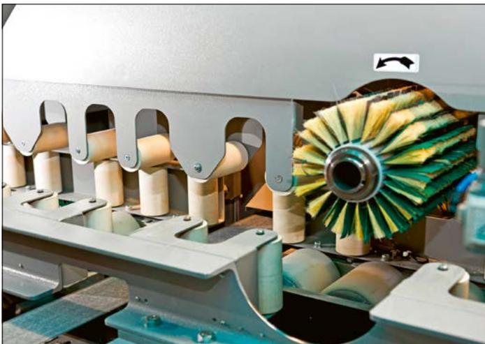
Patentiertes Führungssystem für fertig profilierte Fensterteile
