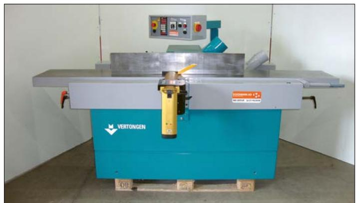
Abricht-Dickenhobelmaschine Vertongen C04
