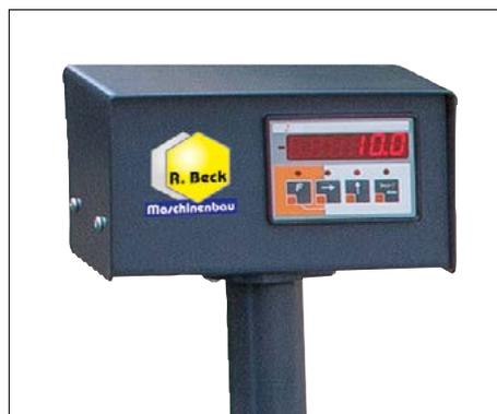
Anzeigegerät Z 58 mit 0,1 mm Anzeige
