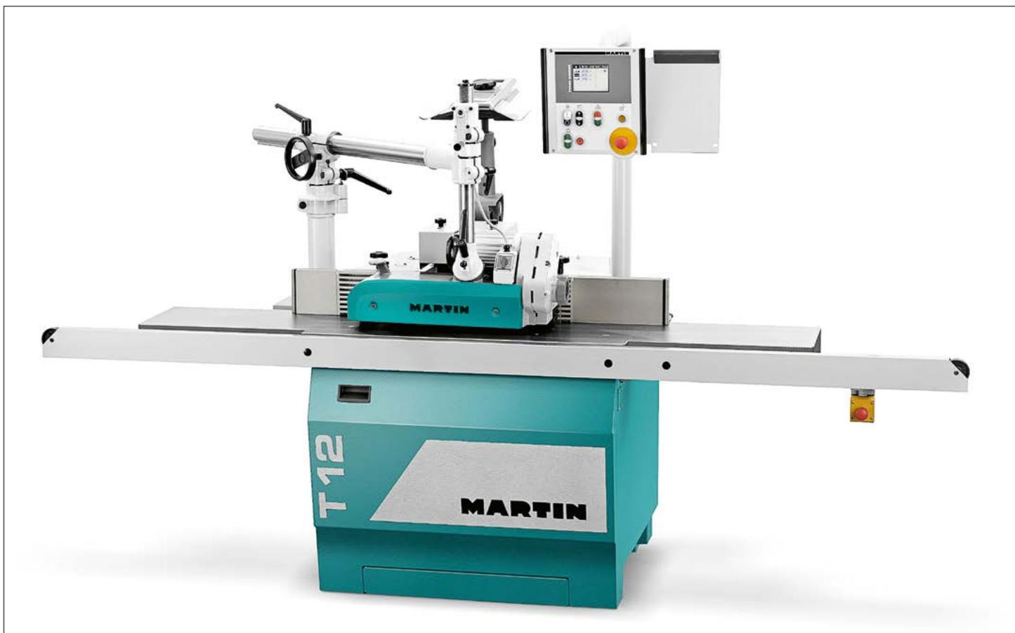
Kehlmaschine Martin T12 mit starrer Spindel
