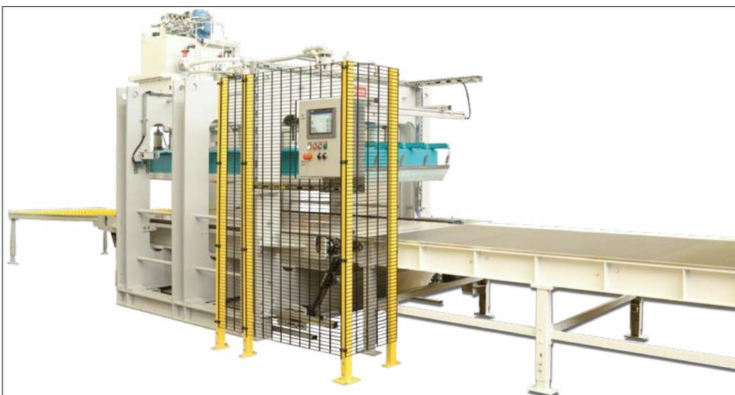
Kurztakt-Durchlaufpresse Höfer HDP, längsbeschickt
