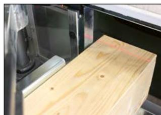
Die Lasertechnik ermöglicht Ihnen, das Werkstück nach Anriss zu positionieren
