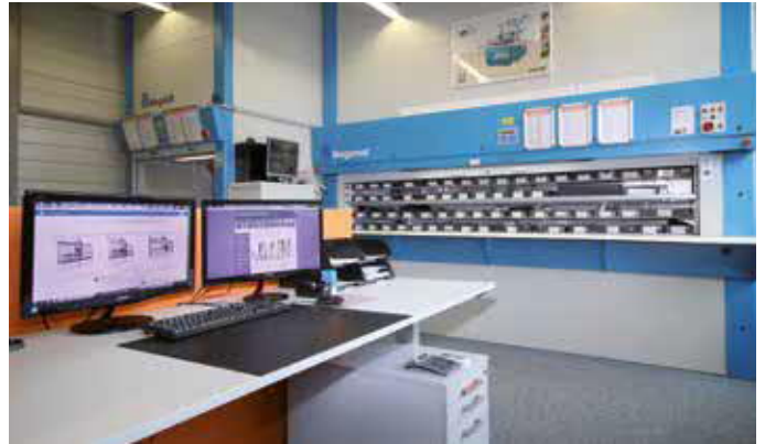
Werkstattbüro mit Hochregallager für Ersatzteile zu Stationärmaschinen.
