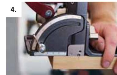
4. Ein zweiter Anschlagwinkel empfiehlt sich, um die Maschine während der Flächenfräsung zu stabilisieren.
