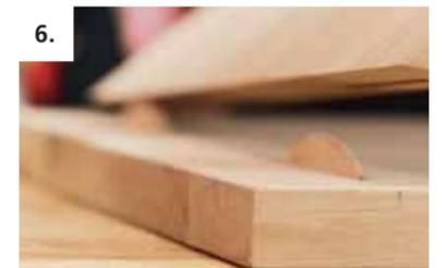
6. Jetzt die stumpfen Winkel zusammensetzen und die Verbindung verleimen.
