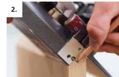
2. Die Position der Mittenmarkierung auf das erste Werkstück übertragen.
