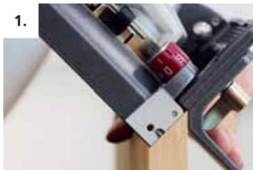
1. Den Anschlagwinkel montieren, die gewünschte Verbindersposition wählen und die erste Nut fräsen.
