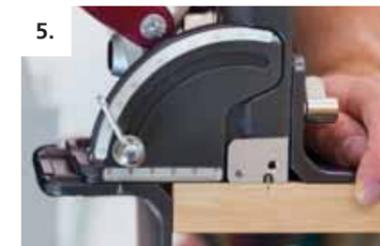
5. Die Mittenmarkierung der Maschine auf die Markierung am Werkstück ausrichten und den Anschlagwinkel für eine exakte Fräsung an der Stirnkante anschlagen.
