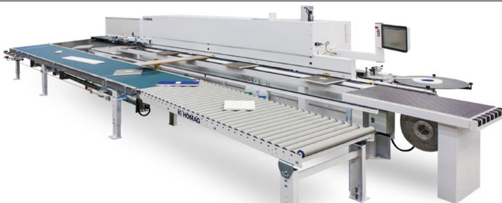
**Rückführung HOMAG LOOPTEQ O-300 in Verbindung mit HOMAG EDGETEQ S-380**
