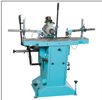
**Langlochbohrmaschine Hess LLB 300**
