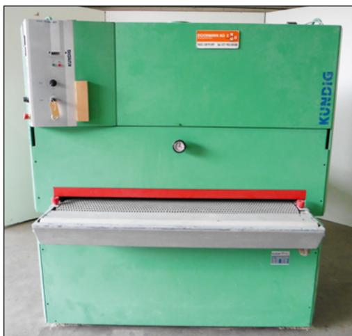
**Breitbandschleifmaschine Kündig Triplex-1350/WWS**
