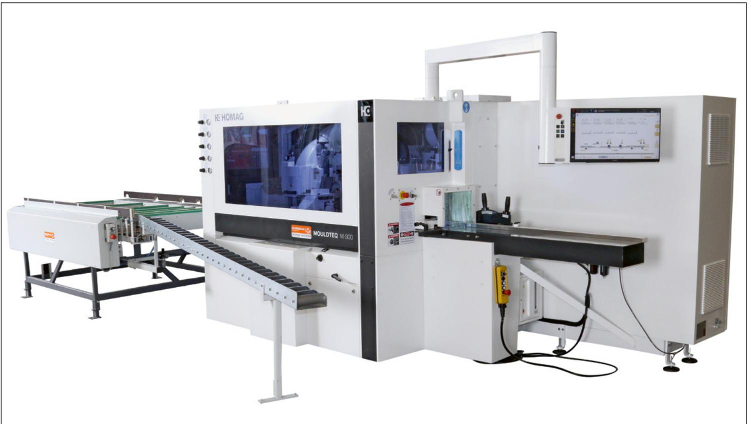
Vierseitenhobelmaschine HOMAG MOULDTEQ M-300 mit Rückführung Neumann
