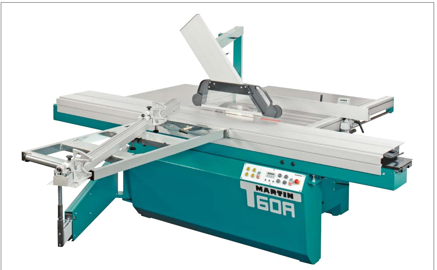
Formatkreissäge Martin T60A mit Schnitthöhenpaket und Untenbedienung
