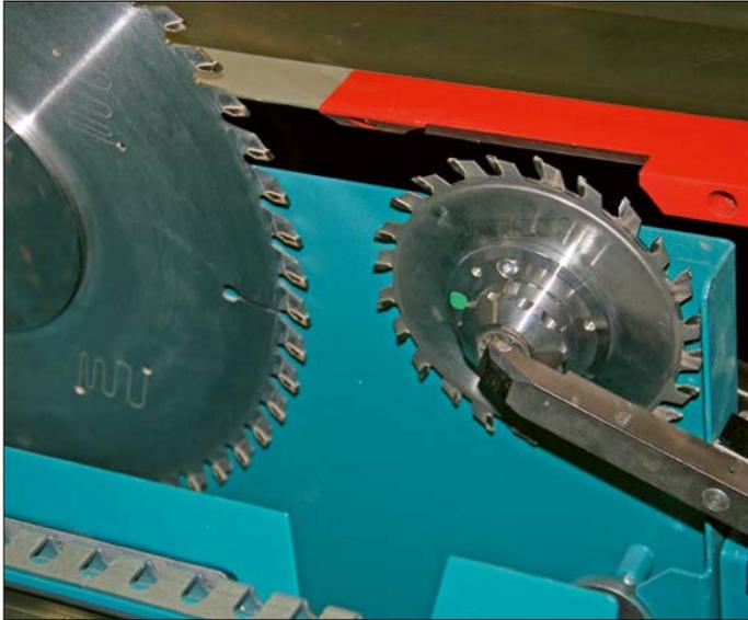
*Elektrisch verstellbares 3-Achs-Vorritzaggregat*
