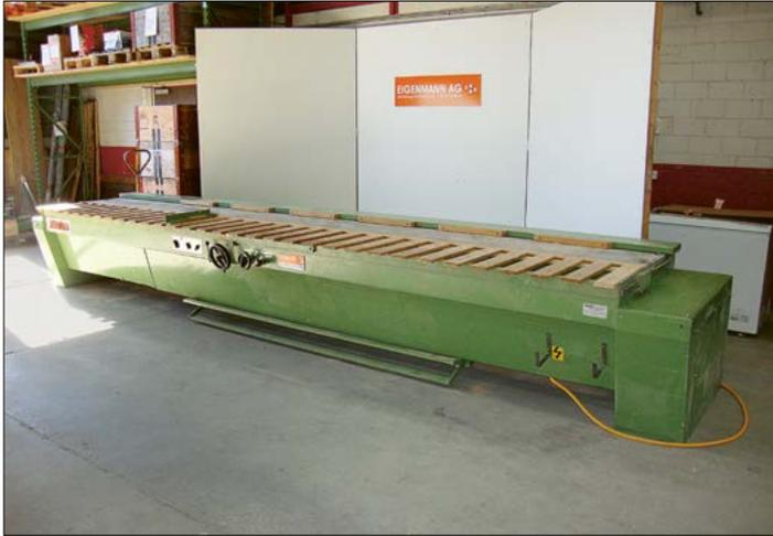
Längskreissäge Jrion HLS
