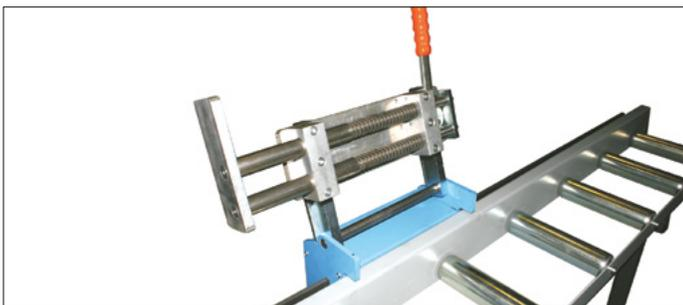
*Manuell wegschwenkbarer Materialanschlag gefedert*
