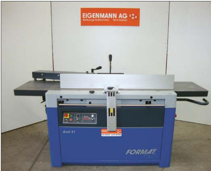
Abricht-Dickenhobelmaschine Felder Dual 51
