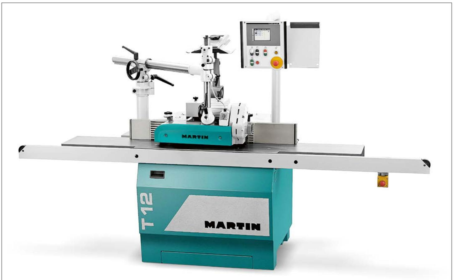
Kehlmaschine Martin T12 mit starrer Spindel
