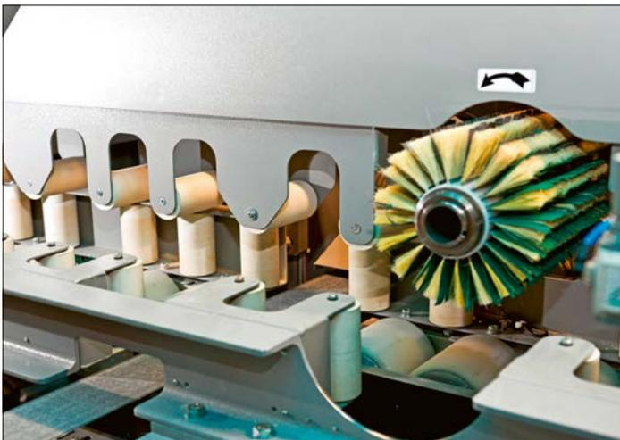
Patentiertes Führungssystem für fertig profilierte Fensterteile
