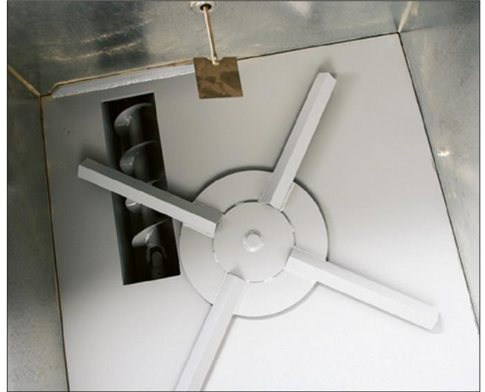
Rührwerk mit Schneckenaustragung
