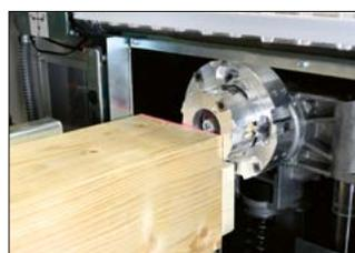
Ob gerade oder schräge Zapfen, die Steuerung ermöglicht eine 4-seitige Bearbeitung in einem Arbeitsgang. Damit sind alle Zapfen auch ringsum angefast
