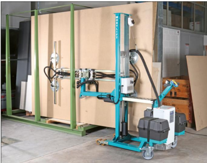
*Entnahme einer Platte aus dem vertikalen Plattenlager*
