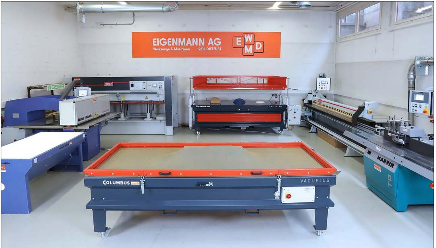
Furnierbearbeitungsmaschinen von Höfer, Fugenverleimmaschine von Fisher & Rückle, Vakuumpressen von Columbus
