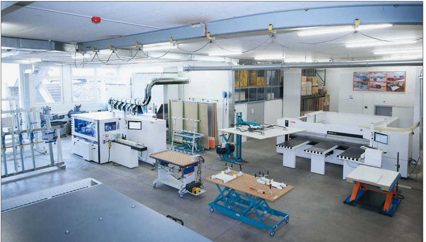
*Vierseitenhobelmaschine und horizontale Plattenaufteilsäge von HOMAG*
