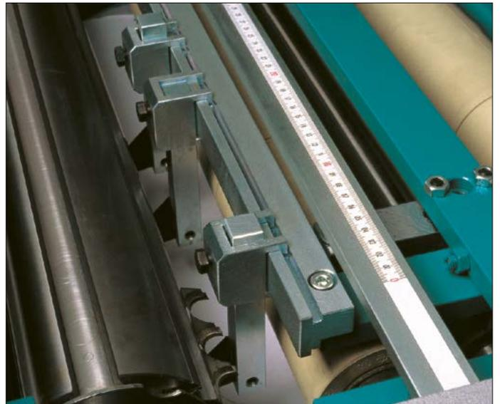
*Sonderdruckeinrichtung für Profilarbeiten*
