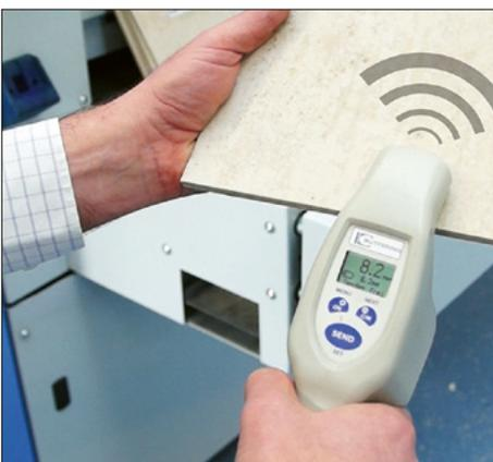
*Dickenmessgerät mit Funkübertragung*
