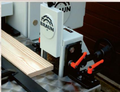
Kantenbürsttaggregat (Sonderzubehör) – auf Wunsch höhenverstellbar und schrägstellbar
