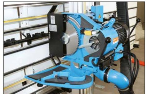
– Schallgedämmtes Gehäuse mit integrierter Absaugung
