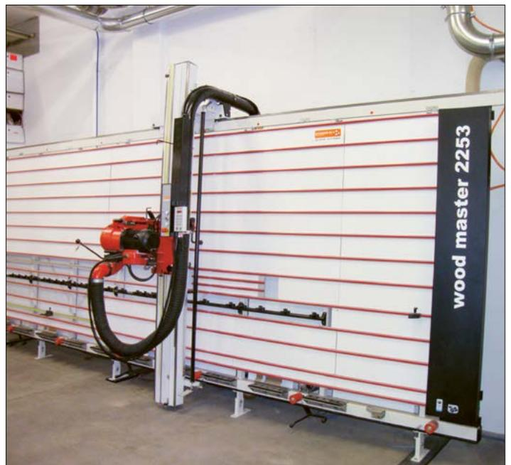
Vertikale Plattensäge Putsch Meniconi wood master 2253
