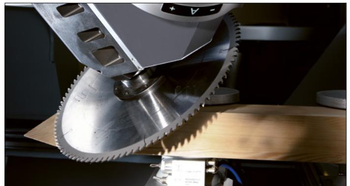
Schifterschnitt mit grosser Schnitttiefe für Rahmenteile
