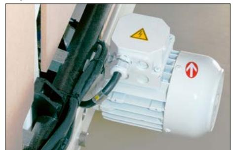
Sägerostverstellung über Elektromotor mit Überlastsicherung
