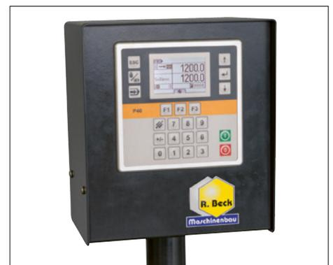
Automatisches Anschlag- und Positioniersystem
