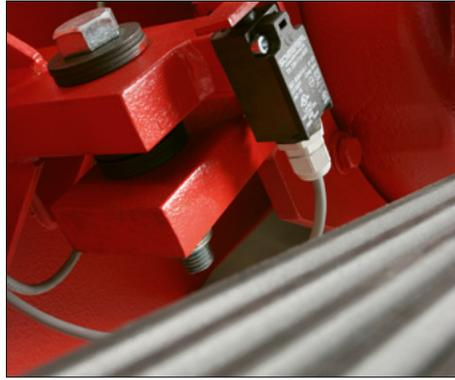
Sicherheitspaket mit Getriebeendschalter und Reversierzähler
