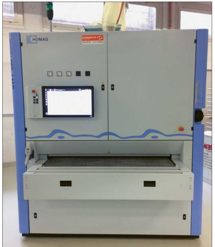
Breitbandschleifmaschine Homag Optimat SWT 335 QCH
