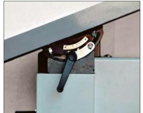
Tischschwenkeinrichtung stufenlos bis 45°
