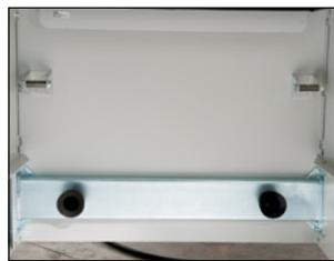
Vakuumstutzen für Spänecontainer
