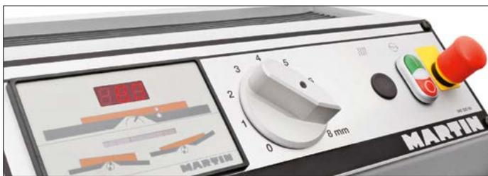
Bedienpult kombiniert und mitfahrend mit Abrichtanschlag
