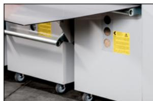
Absperrblech für Spänecontainer
