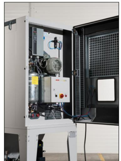
Steuerung mit FU und Löscheinrichtung
