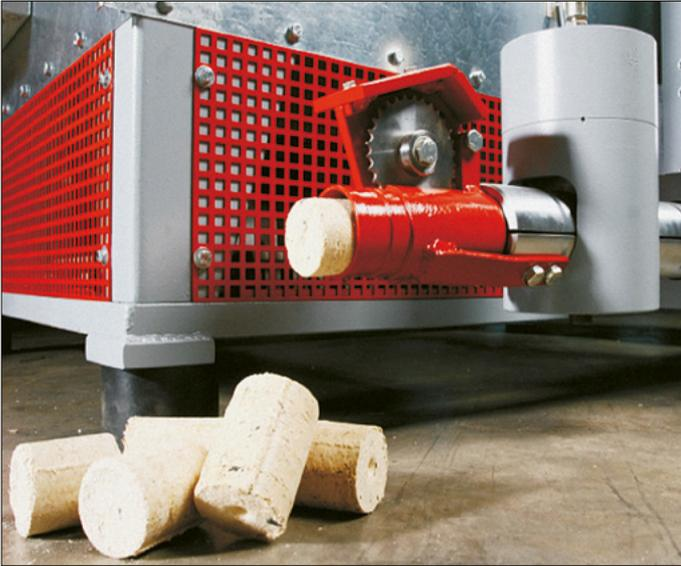
Zangenzylinder mit Stranglängenüberwachung
