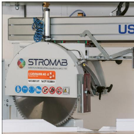
Schutzhaube pneumatisch geöffnet
