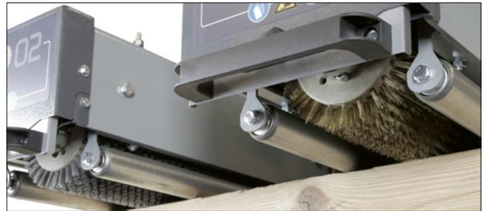
Zwei Bürstaggregate, erstes Aggregat mit Stahlbürste, zweites mit Siliziumkarbid
