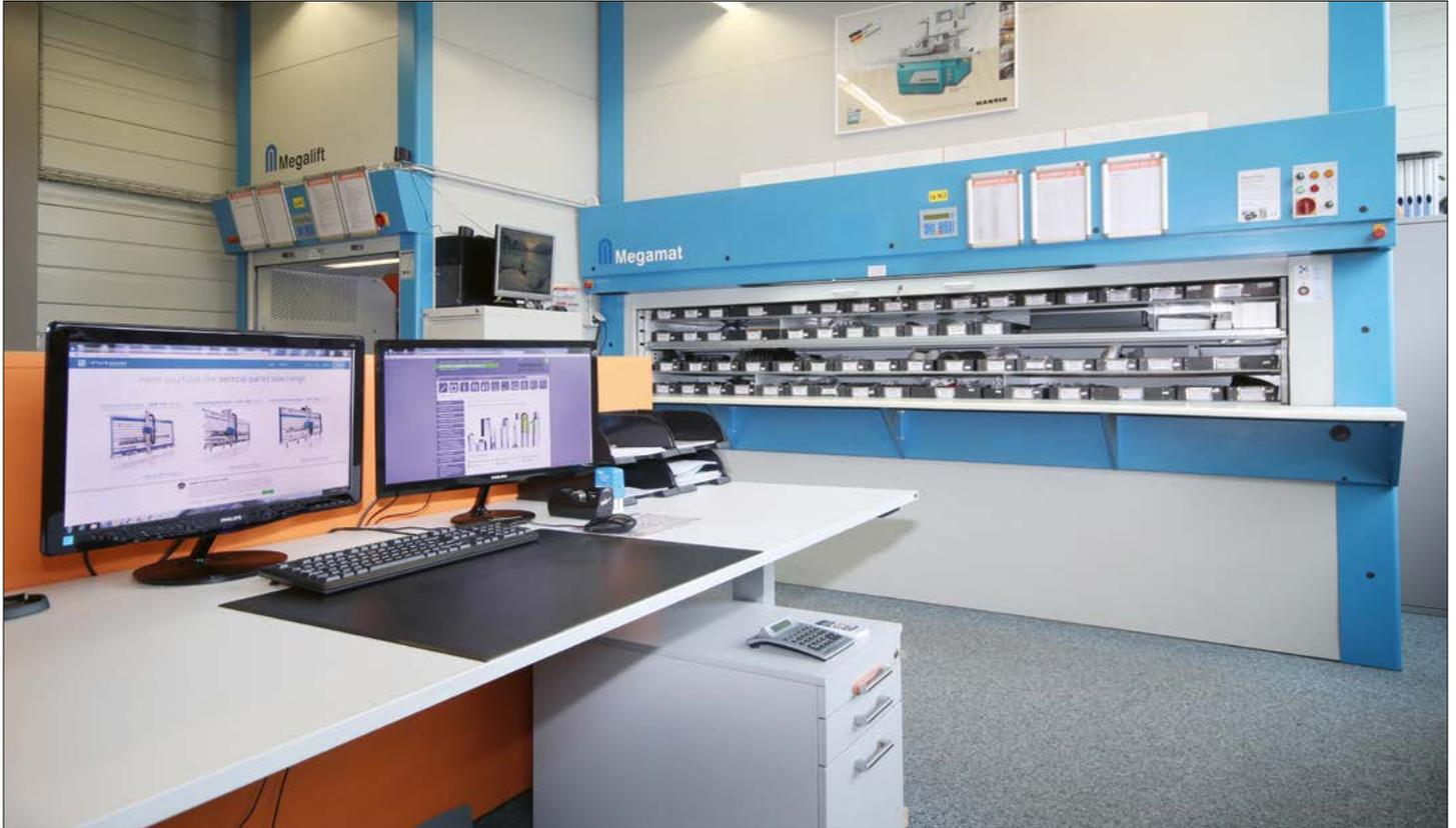
*Werkstattbüro mit Hochregallager für Ersatzteile zu Stationärmaschinen*
