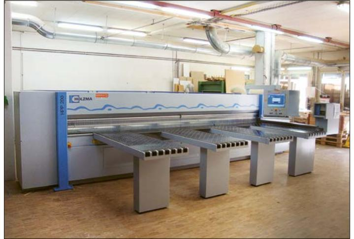
Horizontale Plattenaufteilsäge Holzma HPP 200
