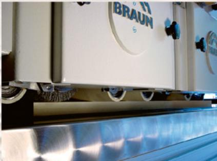
Stabile, robuste Bürsttaggregate mit großen, gefederten und gummierten Druckrollen.
