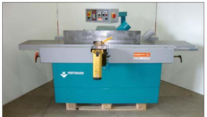
Abricht-Dickenhobelmaschine Vertongen C04
