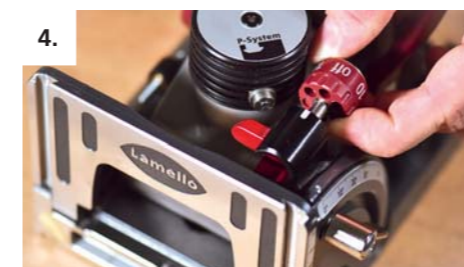
4. Zum Justieren P-System-Tiefensteller ziehen und auf «Off» drehen
