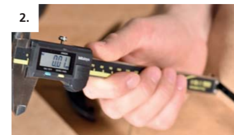
2. P-14 Verbinderhälfte einschieben und Rücksprung messen
