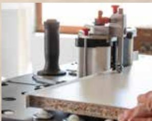
Alle gängigen Nullfugen-Kanten mit einer Materialstärke von 0,4 mm – 3 mm können mit dem HIT-M bearbeitet werden.
